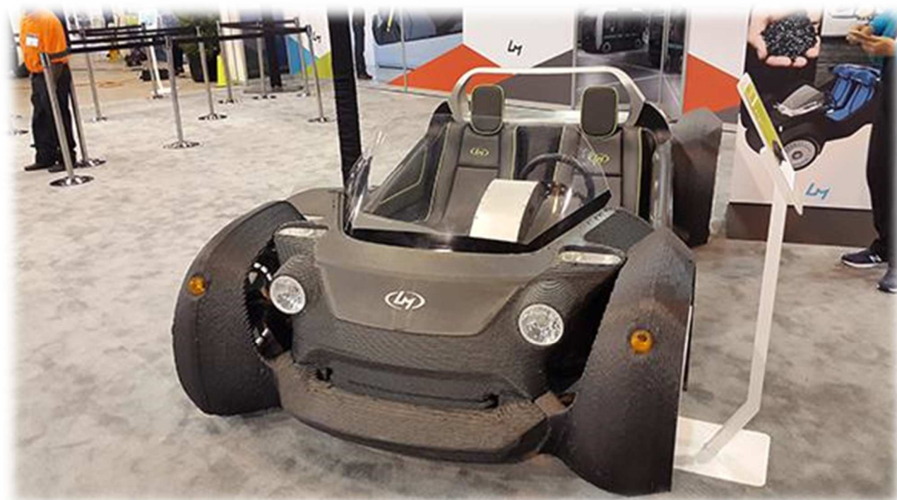
Figure 20 – Carrosserie de marque « Local Motors » fabriquée par impression 3D
