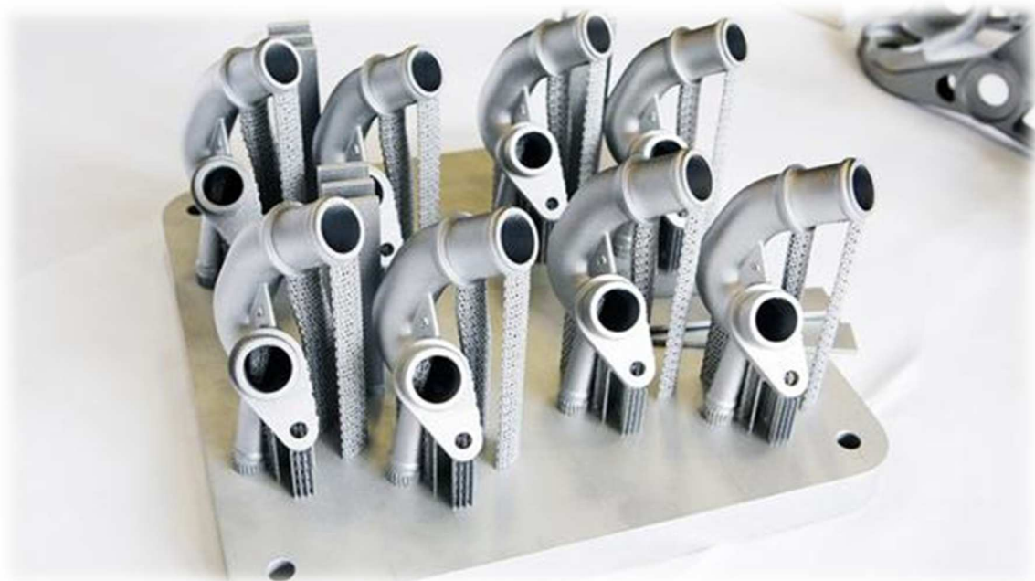
Figure 21 – Fabrication additive – connecteur du circuit de refroidissement, Audi W12
