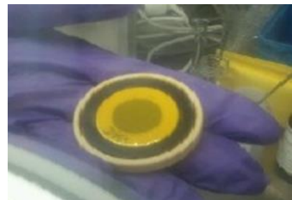
Figure 17 – Porte échantillon utilisé pour les analyses DRX, mise en place d'un film de kapton pour éviter le contact du système avec l'atmosphère ambiante.
