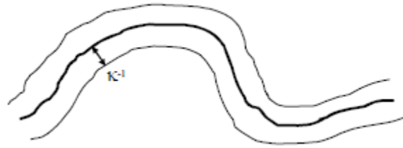
Figure I-1: Représentation de la gaine d'écrantage autour de la chaîne due à la longueur d'écran \kappa^{-1}
