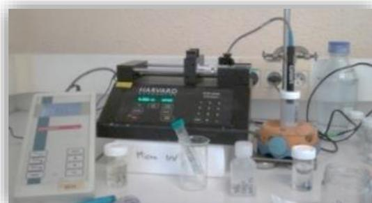
Figure Annexe 2 : Montage utilisé pour les dosages potentiométriques et conductimétriques.
