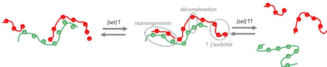
Figure 1-38 : Effet de la force ionique sur les chaînes de PE complexées en solution(adapté de [62]).
