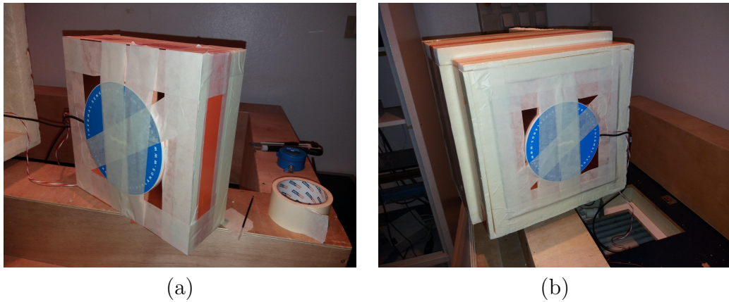
Figure A.10 – (a) Cadre en Styrodur® d’une épaisseur de 10 cm fermé par les plaques de cuivre contenant l’échantillon comprimé, (b) système précédent avec fluxmètres et capteurs de température inséré dans la boîte en Styrodur® avant la caractérisation expérimentale
