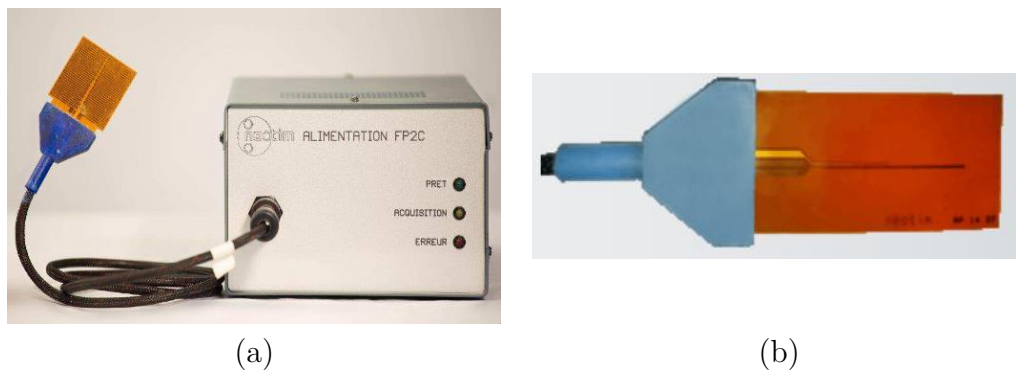
Figure A.8 – (a) Dispositif Fil Chaud, (b) Sonde plane composée d'un fil résistif (Source : http://www.neotim.fr/FP2CConductivimetre.html )
