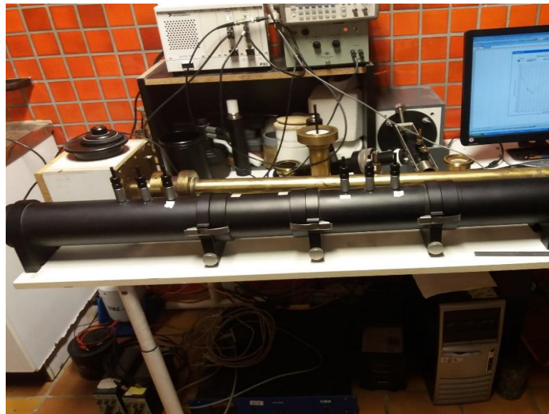
Figure III.17 – Tube d'impédance Bruel & Kjaer Type 4106 de l'ENTPE adapté pour les caractérisations expérimentales de l'effet limp sur les laines végétales
