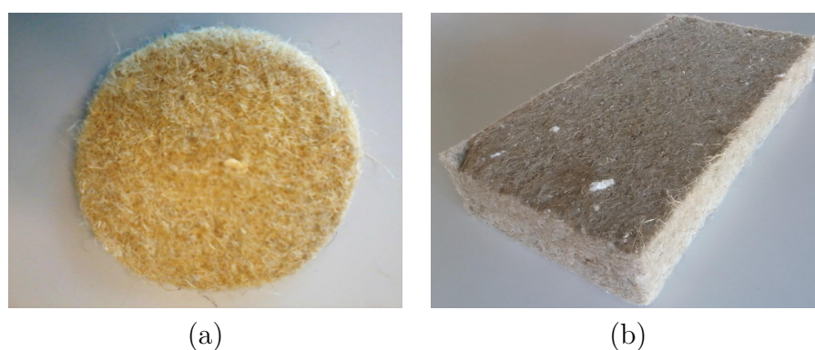
Figure I.10 – (a) Échantillon de laine de chanvre aiguilleté, (b) Panneau semi-rigide de laine de chanvre
