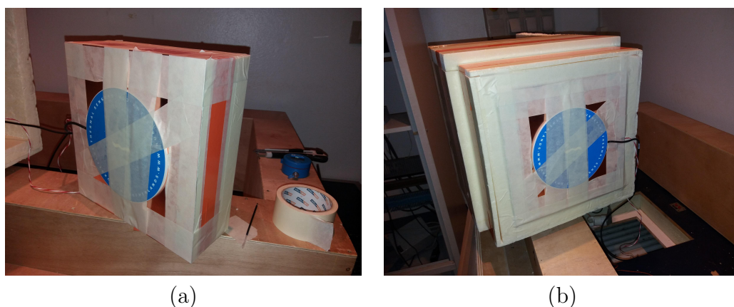
Figure A.10 – (a) Cadre en Styrodur® d’une épaisseur de 10 cm fermé par les plaques de cuivre contenant l’échantillon comprimé, (b) système précédent avec fluxmètres et capteurs de température inséré dans la boîte en Styrodur® avant la caractérisation expérimentale
