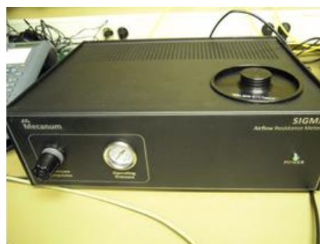
Figure A.3 – Résistivimètre SIG2014
