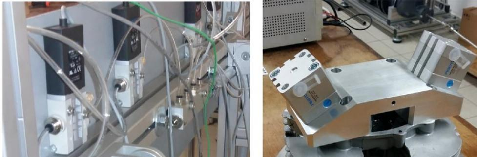
FIGURE 2.21 – Vérins et distributeurs pneumatique du banc d'essais de [Ngangue et al., 2019].
