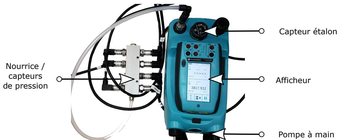
FIGURE 4.21 – Caractérisation des capteurs de pression.
