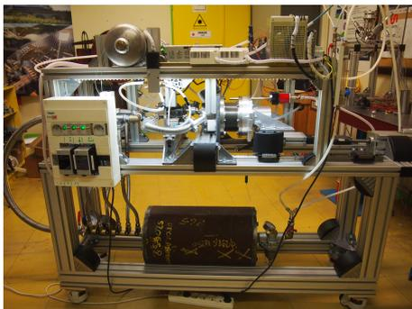
Banc d'essai de l'enceinte de détente à soupapes comprenant des réchauffeurs électriques, une charge mécanique et des auxiliaires.
