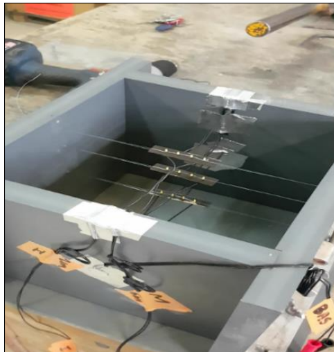
Figure 4-17 Vue des 3 dispositifs Wenner respectivement à 2 cm, 6 cm et 10 cm de profondeur dans le récipient cubique dans lequel le béton a été coulé par la suite.
