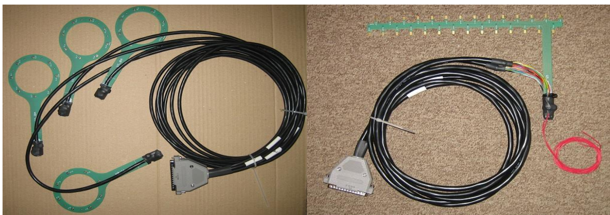
Figure 5-8 Vue des dispositifs noyés dans les corps d'épreuve avec leur connecteur DB37 : (a) série de 4 dispositifs Anneau, (b) 1 dispositif Echelle à 28 électrodes.
