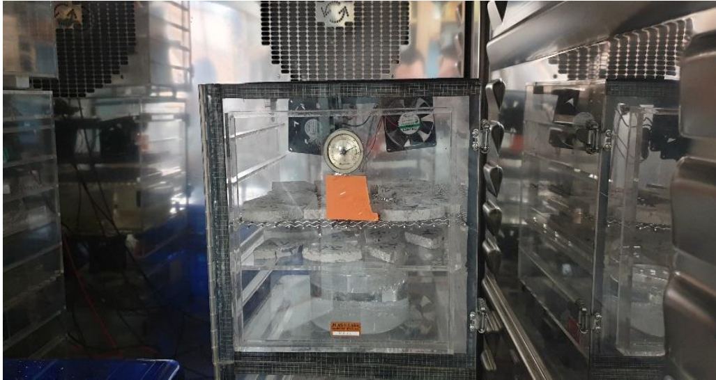
Figure 5-28 Vue d'un dessiccateur dans une enceinte à 45°C
