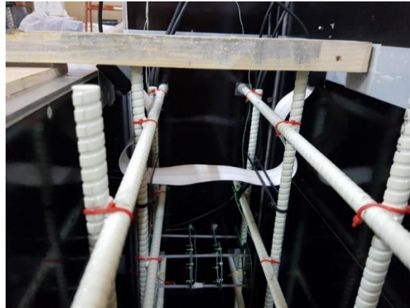
Figure 5-5 Vue des mailles d'armatures en fibre de verre (avant coulage) et du capteur TDR implémenté dans la dalle FV.
