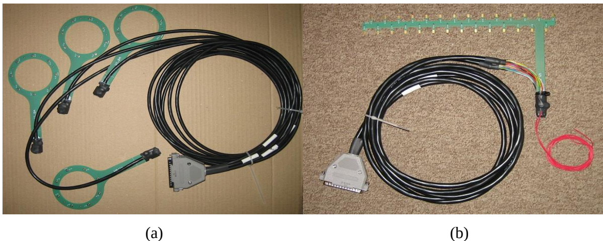
Figure 5-8 Vue des dispositifs noyés dans les corps d'épreuve avec leur connecteur DB37 : (a) série de 4 dispositifs Anneau, (b) 1 dispositif Echelle à 28 électrodes.
