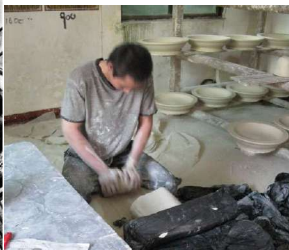
Figure B8 : Malaxage de l'argile, Jingdezhen. Photographie : N. Balard (Balard, 2012).
