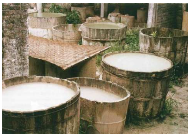
Figure B5 : Mise en lévigation de l'argile dans des baquets, Jingdezhen. Photographie : M. Bai (Bai 2005).
