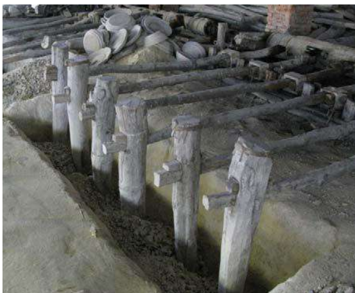
Figure B2 : Pilon à eau traditionnels, Jingdezhen Photographie : N. Balard (Balard 2012).
