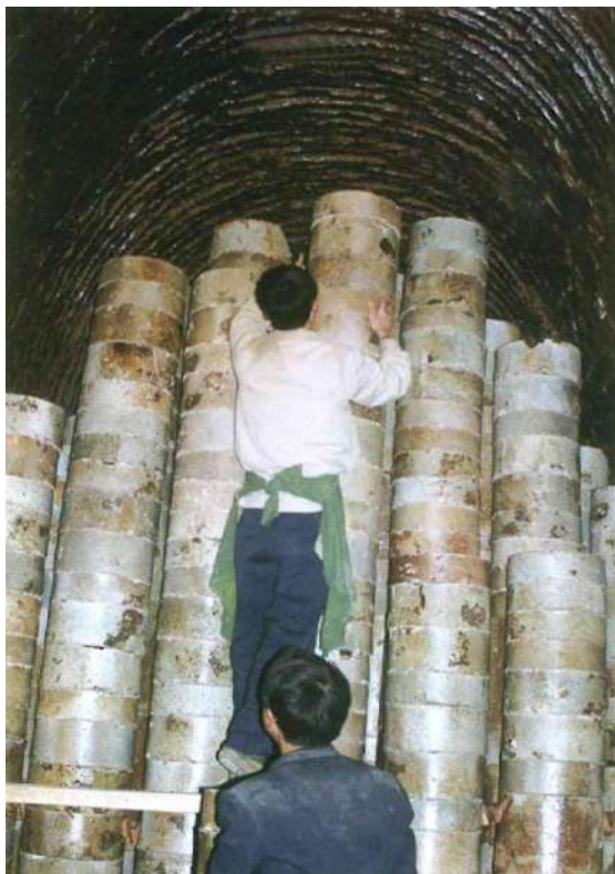
Figure B18 : Chargement du four, empilement des cassettes dans la chambre, Jingdezhen. Photographie : M. Bai (Bai 2005).
