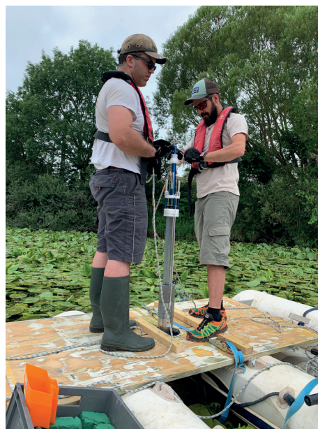
Figure 107 : Plateforme et carottier d'interface. C. Schaal, 2019
