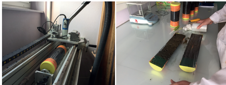
Figure 69 : Banc de découpe et emballage des deux parties de la carotte. C. Schaal, 2017
