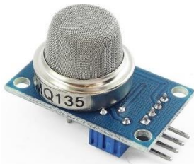
Figure 2.10 : Exemple de capteur MOS ( \text{SnO}_2 ) à bas coût (MQ-135) pour la mesure des COV.
