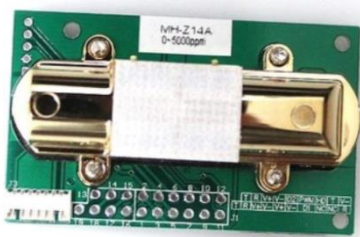
Figure 2.14 : Exemple de capteur à bas coût NDIR pour la mesure du \text{CO}_2 : MH-Z14.
