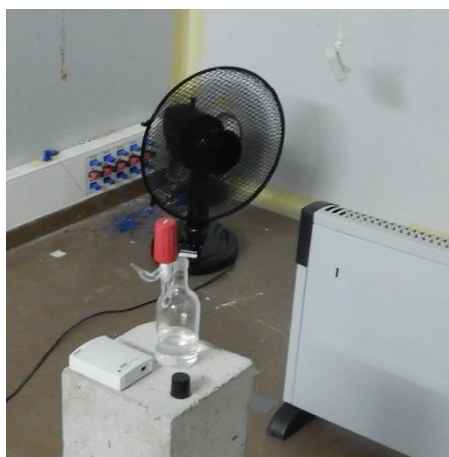
Figure 4.2 : Photographie de la source d'hexane, du ventilateur et du radiateur utilisés au sein de la cellule PASSYS. D'après (Laverge, 2017).
