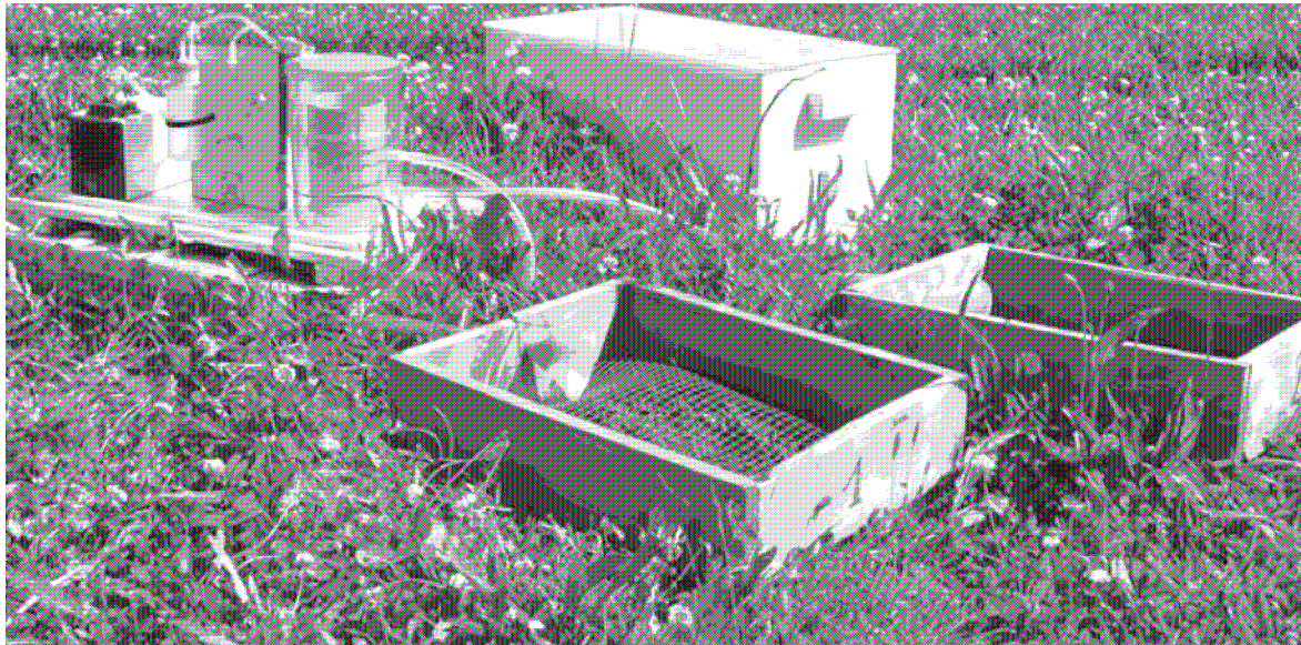
Figure 21: Piège Marchi (capot ôté). On distingue de gauche à droite la pompe, le cylindre rotatif protégé par un capot transparent, et l'installation des flexibles d'aspiration sur deux lits de feuilles (Photo Michel Giraud)
