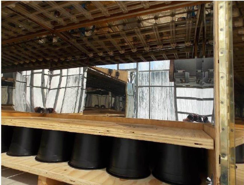
Figure 69 : Étagère amovible permettant d’ajuster la distance entre les plantes et les lampes UV-C. (Photo : Frédéric Pascal, INRA PACA).
