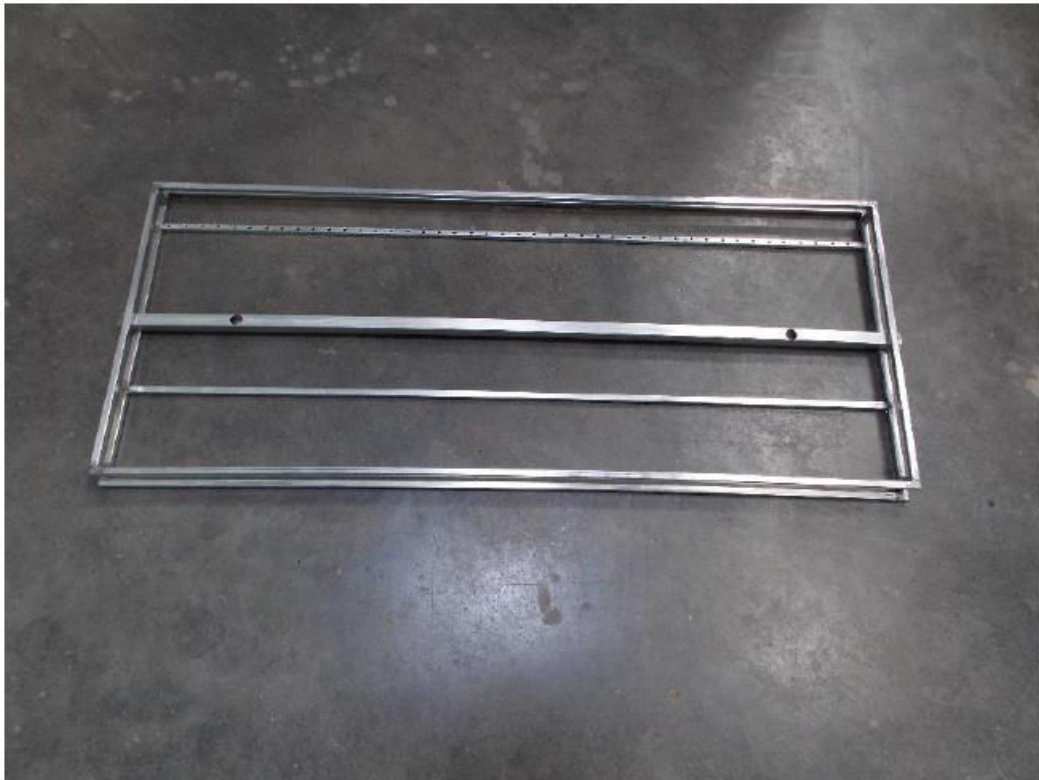
Figure 70 : Châssis support des lampes et des ballasts. (Photo : Frédéric Pascal, INRA PACA).
