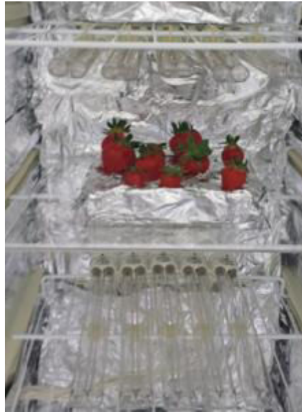
Figure 22 : Traitement UV-C des fraises. Deux étages de lampes UV-C sont séparés par un étage composé d'une plaque en quartz.
