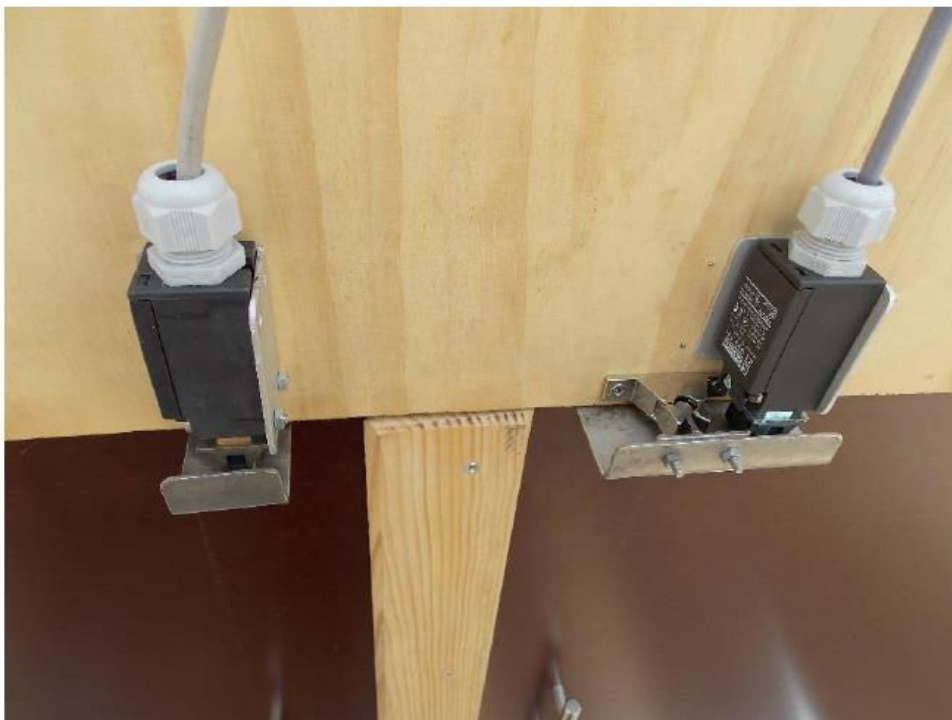
Figure 73 : Contacts de sécurité des portes et du loquet de maintien. (Photo : Frédéric Pascal, INRA PACA).
