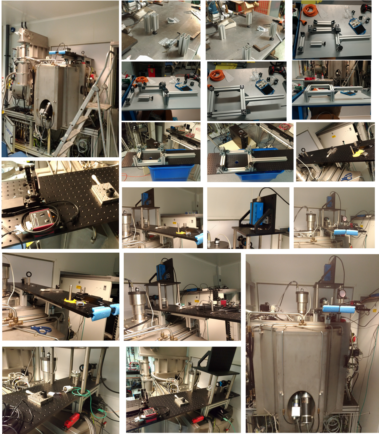
FIGURE 3.58 – Étapes de réalisation et d'intégration du châssis assurant l'interfaçage entre le banc de mesure de phase et la machine de dépôt DIBS
