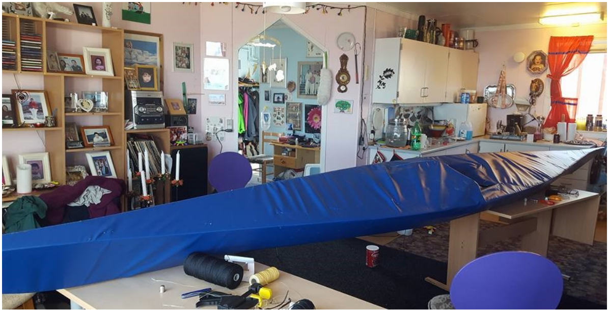
Figure 228 - La structure est recouverte de toile - Photo de Dan Norman - Qaanaaq 2017
