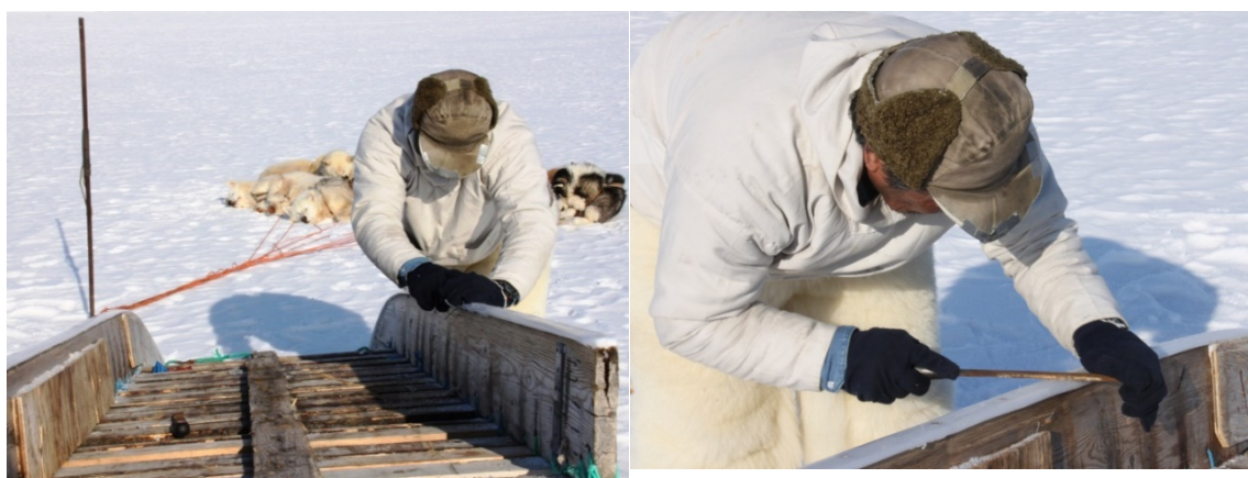
Figure 169 - Polissage des semelles des patins
