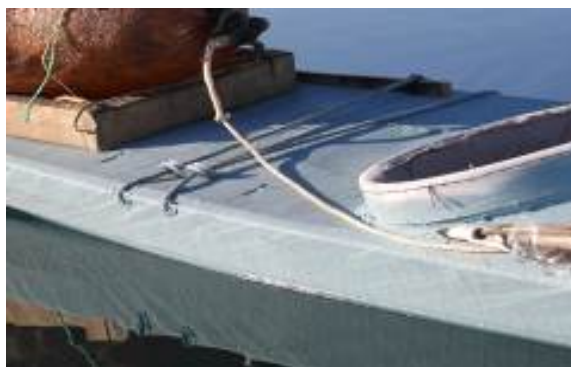
Figure 230 - Fixation du revêtement autour de l'hiloire. Fjord Inglefield. 2010
