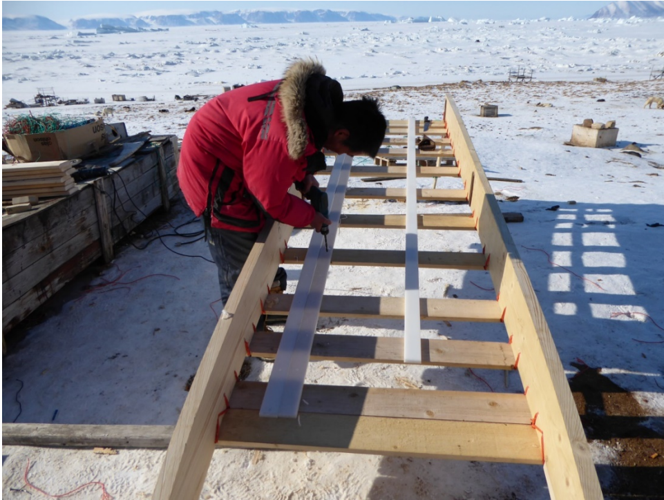
Figure 159 - Une semelle est fixée sous les patins
