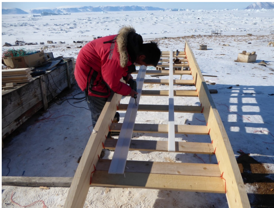
Figure 159 - Une semelle est fixée sous les patins
