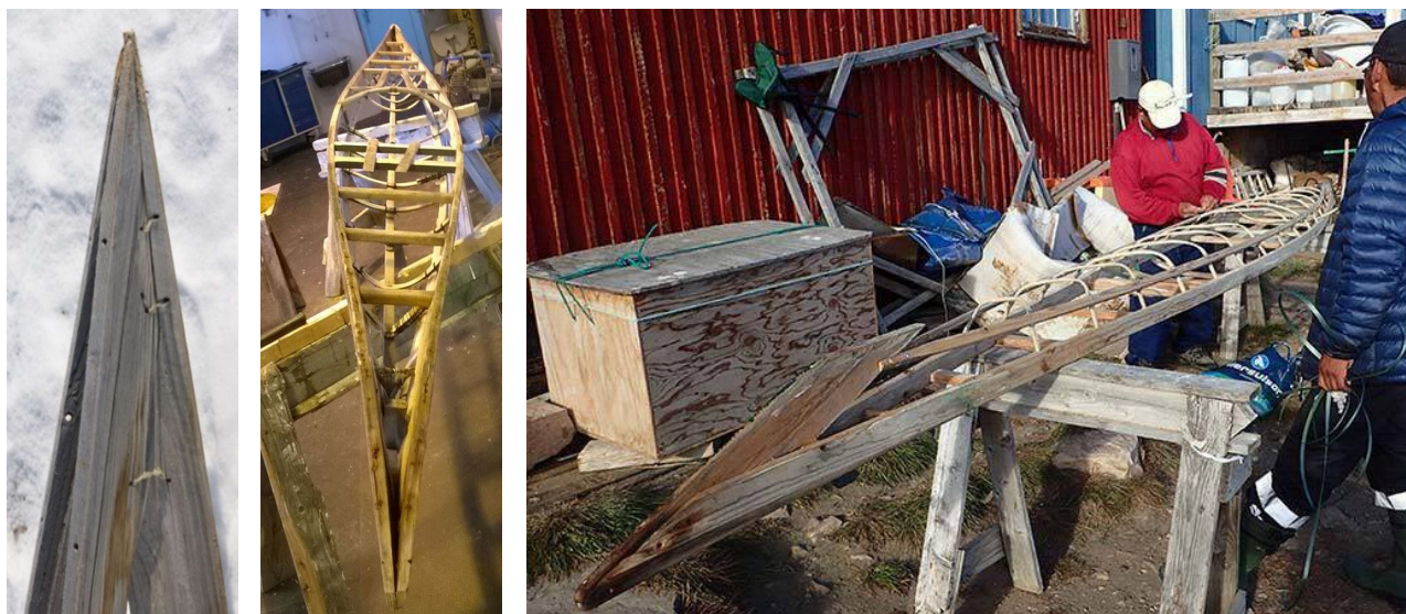
Figure 226 - Construction de la charpente d'un kayak. Qaanaaq. 2016
