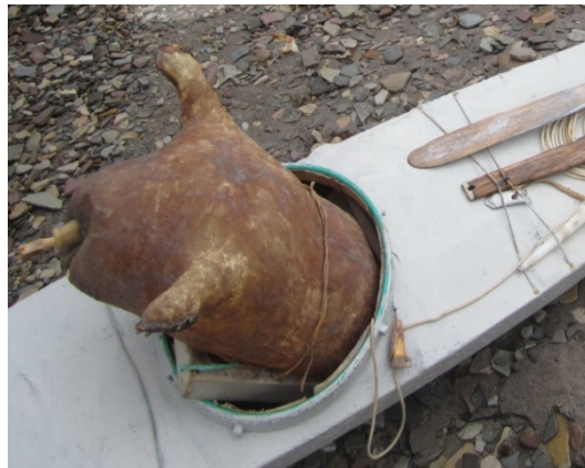
Hiloire et lanières de pont du kayak de Kristian Eipe en 2016 sur la plage de Narsaq
