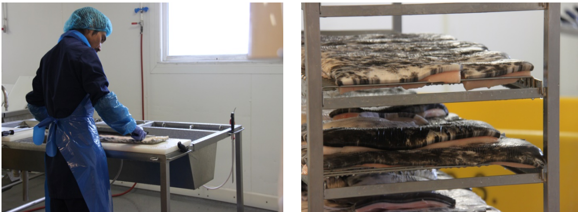
Figure 358 - Rinçage et calibrage des plaques de mattaaq
