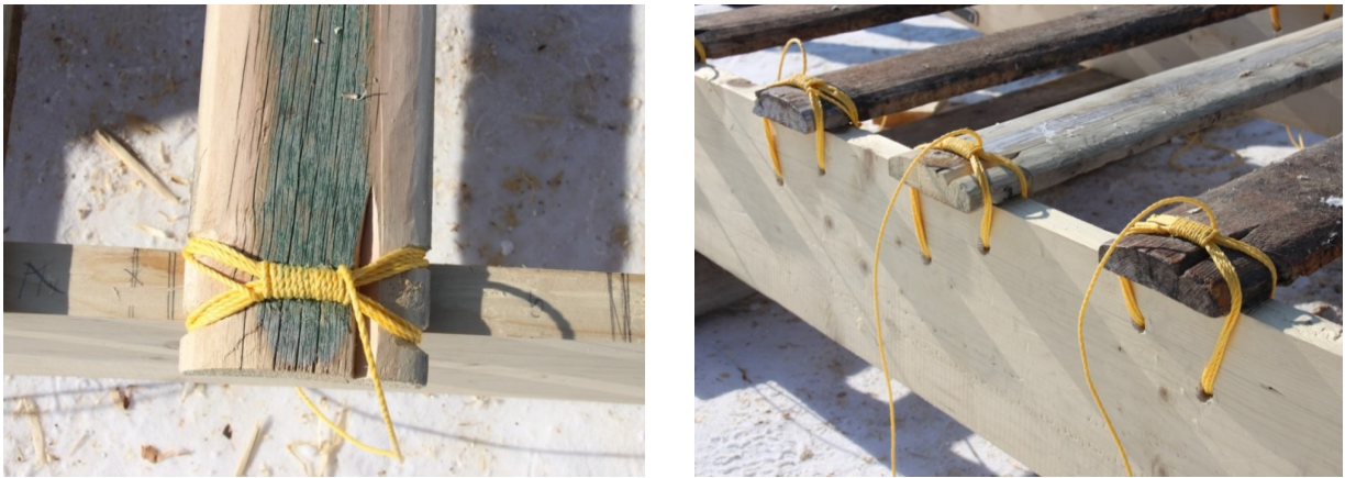
Figure 157 - Epissures de maintien des lattes sur les patins
