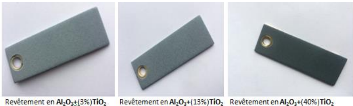
Figure 50. Photographies des revêtements composite Alumine-Titane obtenus par (APS)
