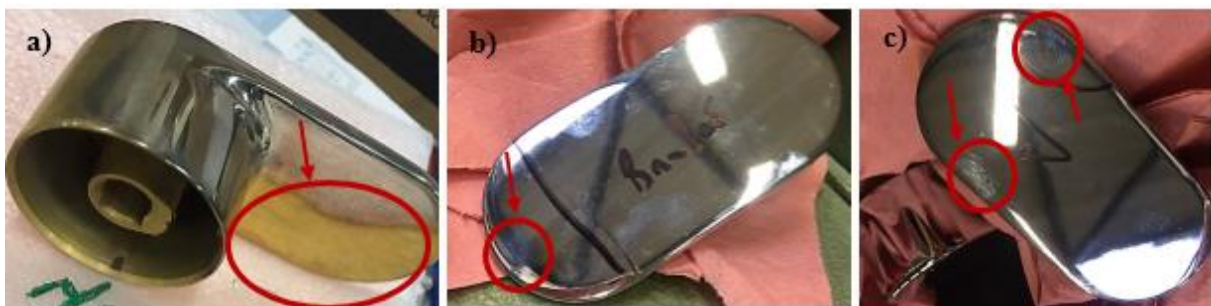
Figure 5. Exemples de défauts du chromage électrolytique : a) Non-revêtu, b) Brûlure, c) taches
