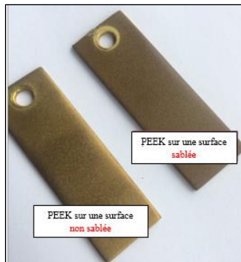
Figure 65. Revêtements PEEK élaborés par la projection à la flamme simple
