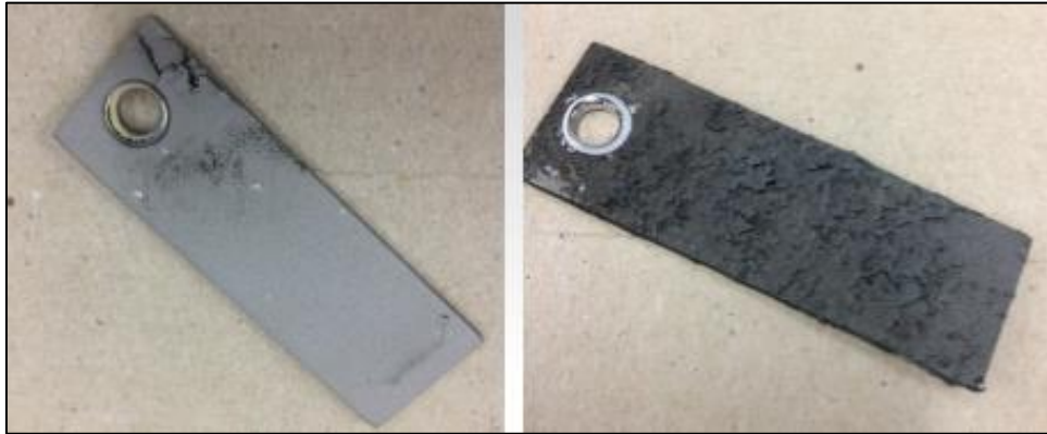
Figure 49. Problèmes d'adhérence mécanique des revêtements céramiques dus à l'absence de préparation de la surface avant la projection thermique
