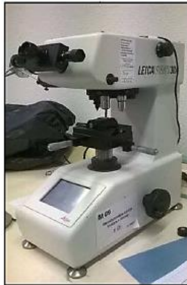
Figure 48. Dispositif de mesure de la microdureté (LERMPS/Sevenans)
