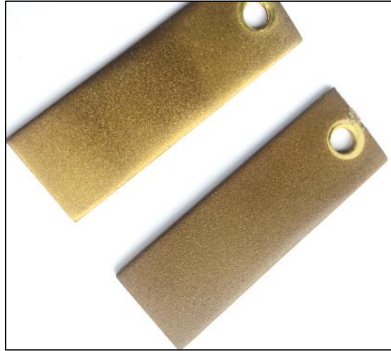
Figure 69. Photographie de la surface du revêtement PEEK prise après le test de corrosion.
