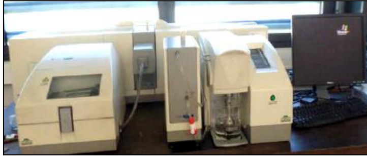
Figure 36. Photographie du dispositif de mesure de la granulométrie (LERMPS/Montbéliard)
