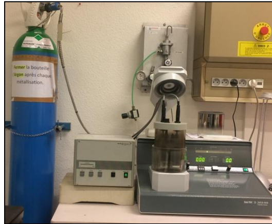
Figure 38. Photographie de l'appareil de carbonisation (LERMPS/Montbéliard)
