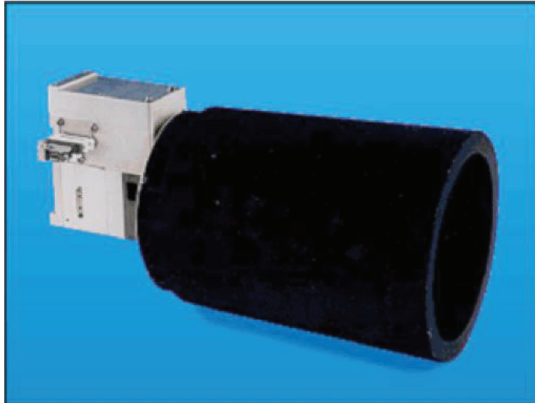
Figure 3.1: Caméra haute résolution (HIRES) de la sonde Clementine (Crédit : NASA).
