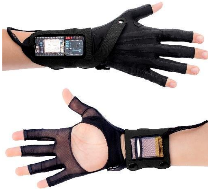
Figure 14 : Image des Mi.Mu gloves 93 . Des capteurs intégrés permettent de mesurer la flexion des doigts, la position des mains dans l'espace et leurs mouvements.
