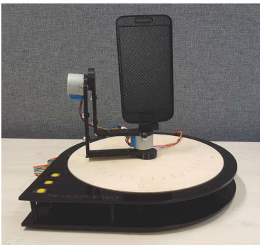
Figure 51 Le Gigoteur (SENSe, 2014b), bras articulé qui restitue le mouvement d'un téléphone à partir de l'enregistrement d'une série de capteurs.
