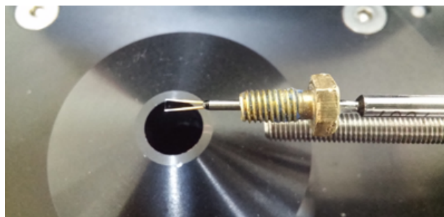
FIGURE 4.18 – Capteur à fil chaud montée sur le banc de calibration
