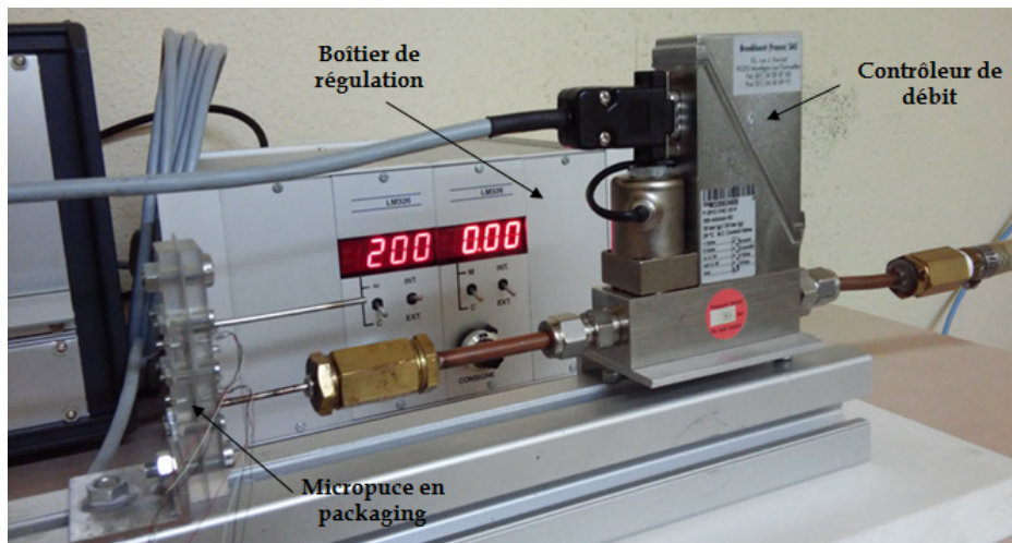
FIGURE 4.9 – Banc d'essai pour un écoulement permanent unidirectionnel
