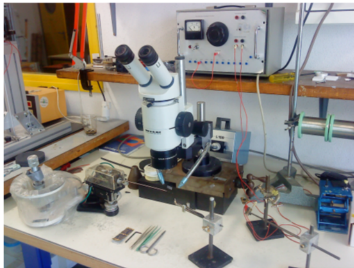
FIGURE 4.24 – Banc de soudure microthermocouple par décharge capacitive [?]
