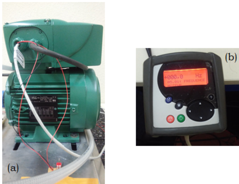
FIGURE 4.6 – Système d'entraînement : (a) moteur électrique, (b) variateur de vitesse angulaire
