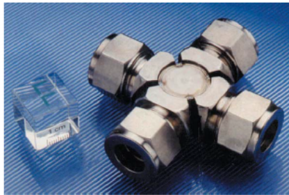
FIGURE 1.38 – Micro-échangeur métallique à courants croisés [18]
