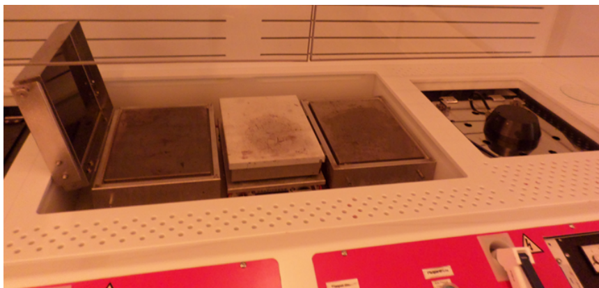
FIGURE 2.13 – Machine pour le “spin coating” de la photorésine + plaque chauffante pour le recuit
