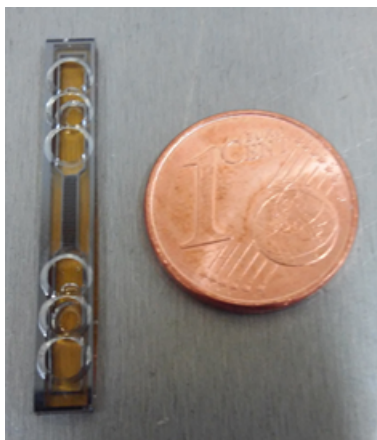
FIGURE 2.23 – Micropuce régénérateur après découpe
