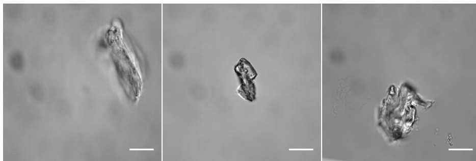
Figure II. 3 : Agrégats de collagène ayant subi des cycles de congélation/décongélation. La barre d'échelle correspond à 20 \mu\text{m} .
