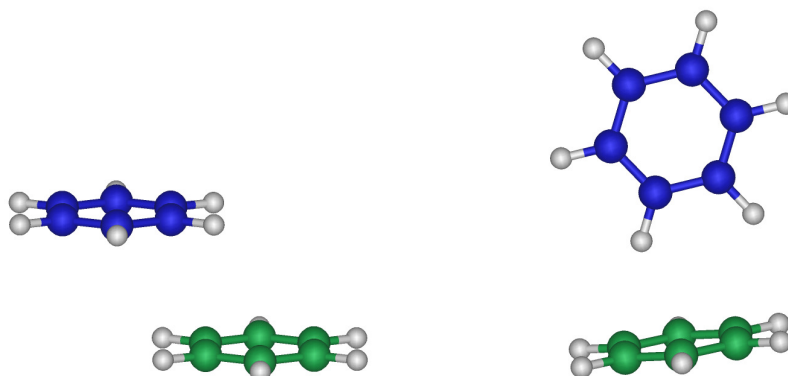
FIGURE 1.5 – Structures les plus stables pour le dimère de benzène : structure de type sandwich à gauche et structure de type T-Shaped (ici, la structure la plus stable dite Cs-over-bond ) à droite
