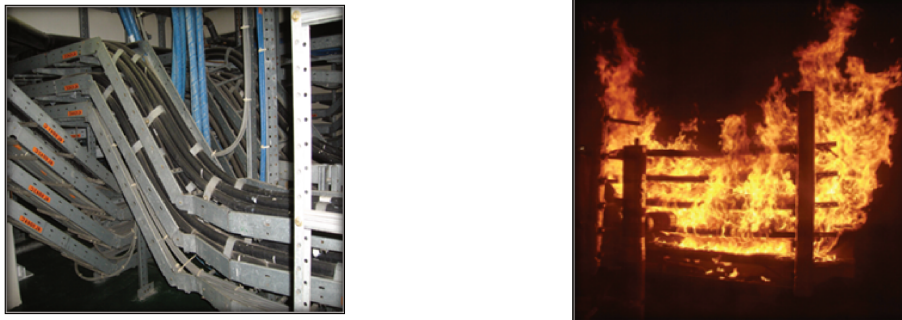
FIGURE 1.1 – Feu du câble en grande échelle
