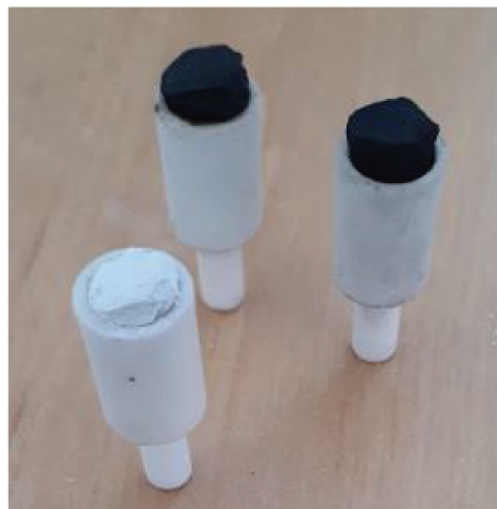
FIGURE 5.8 – Photo des échantillons à caractériser par tomographie dans un creuset à alumine : échantillon noir : matériau EVA-ATH à l'état intermédiaire ; échantillon blanc : matériau EVA-ATH à l'état final.
