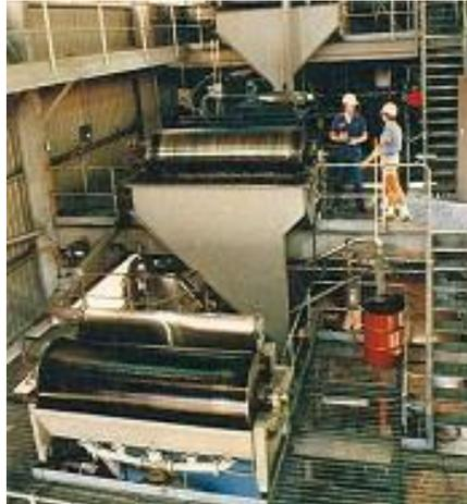
**Figure 6 : Tambours magnétiques utilisés dans le procédé SIROFLOC**
