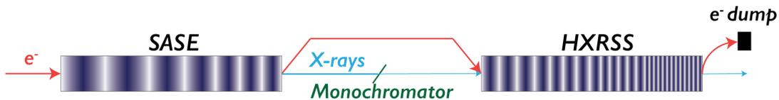
Figure 5.2 : Principe de fonctionnement du mode HXRSS d'un XFEL
