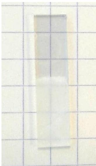
Figure 39- Dépôt de ZnO réalisé dans le BMIMTFSI contenant 0,15M de  $BMIMNO_3$  et 0,05M de  $Zn(TFSI)_2$ .
