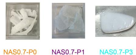
FIGURE 6.4 – Observations des verres NAS0.7-Pn traités thermiquement à 825°C pendant 4 h.
