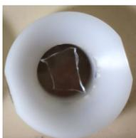
FIGURE 2.12 – Échantillon étudié, placé dans un porte échantillon lors d'une expérience DNPA, entre deux fenêtres de verre de silice
