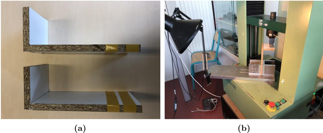
**FIGURE 1.25** – (a) Les 2 types d'éprouvettes de jonctions, et (b) le montage de fixation
