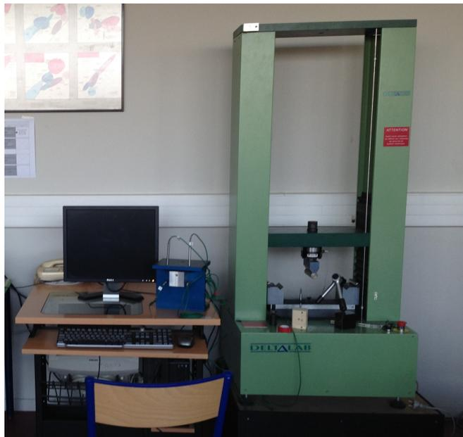
FIGURE 1.3 – Machine d'essai universelle DELTALAB EM 550
