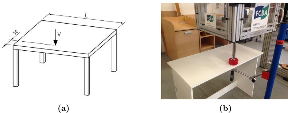
FIGURE 3.13 – Essai de stabilité verticale : (a) mode d’essai dans la norme et (b) essai réel
