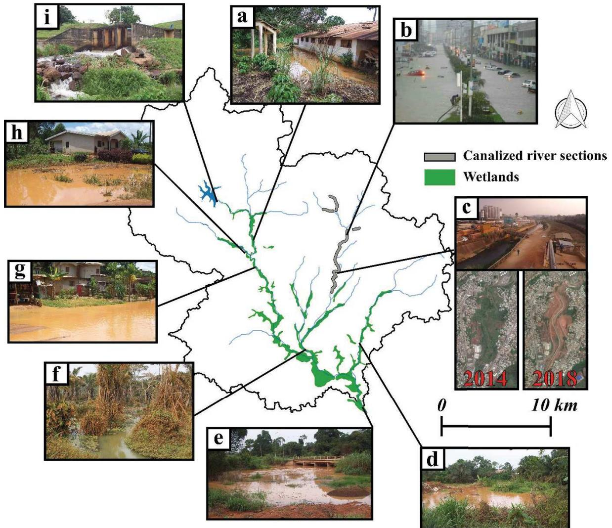
**Figure 5.3.** Estimation de l'emprise des zones humides propices à des débordements récurrents (zones vertes). Les photos présentent des exemples de débordements observés pendant la période de suivi hydrologique 2017-2019 et des aménagements le long du réseau hydrographique.
