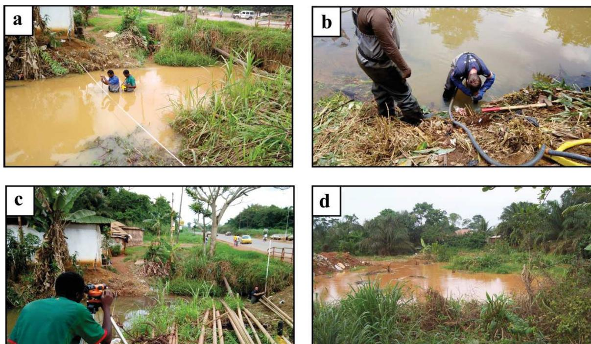
**Figure 4.7.** a) Mesure de débit à la station Anga'a (vue depuis la rive gauche) ; b) Installation de la station Anga'a (Leonel Yossa, 2017); c) Mesure topographique à la station Anga'a (David Badoga, 2017); d) Zone de débordement lors d'un événement pluvieux en amont de la station Anga'a (Alain Fezeu, 2017).
