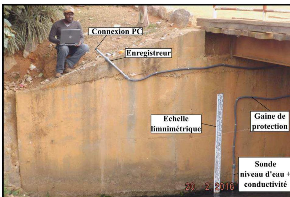
**Figure 4.1.** Installation type d'une station hydrométrique (une sonde OTT-CTD) déployée pendant la phase d'instrumentation sur le bassin de la Méfou. La station représentée est la station S<sub>4</sub>-Ecopark, drainant 21 km<sup>2</sup> du bassin de la Biyeme.
