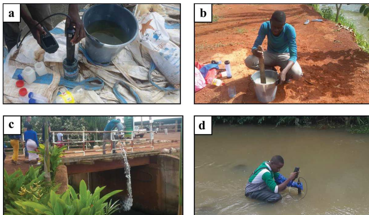
Figure 4.11. a ) Elaboration de la courbe étalon pour le jaugeage chimique (Leonel Yossa, 2017); b ) Préparation du traceur (Eau + Sel) injecté en rivière pour le jaugeage chimique (Moustapha Djangue, 2017); c ) Injection du traceur (Eau + Sel) (Moustapha Djangue, 2017); d ) Mesure de la conductivité électrique en aval du point d'injection (David Badoga, 2017).
