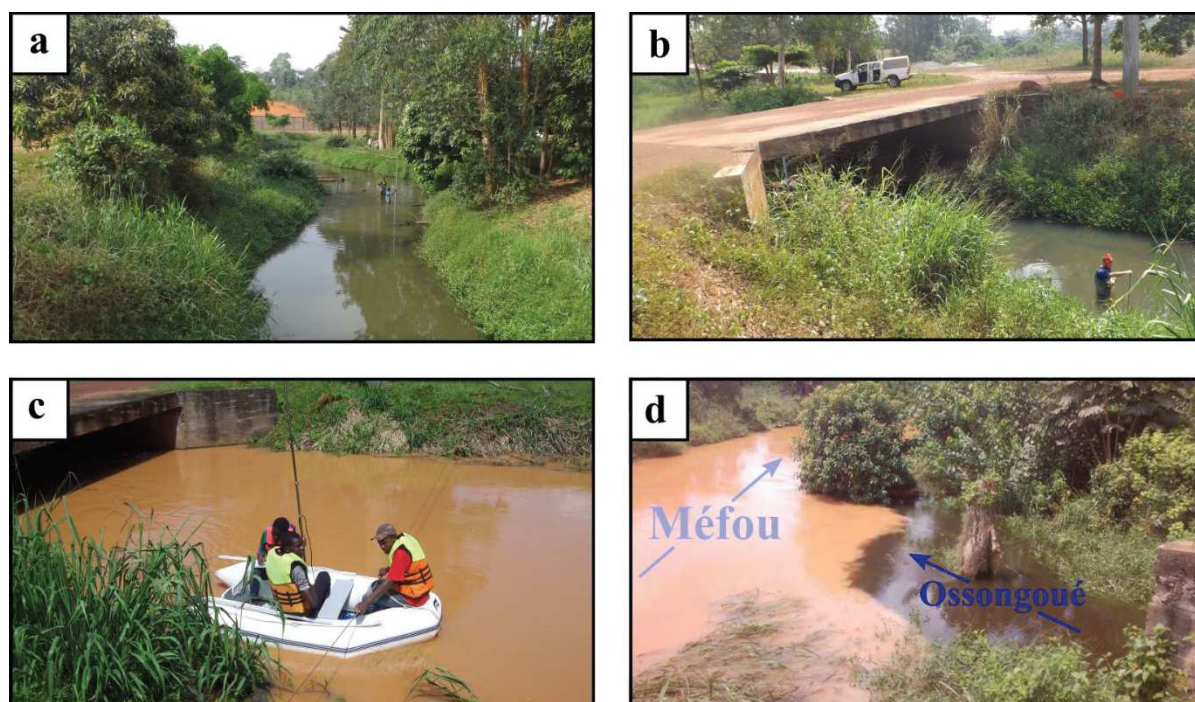
Figure 4.5. a) Rivière de la Méfou au niveau de la station Canabois (vue vers l'amont) ; b) Mesure de débit au niveau de la station Canabois en période de basses eaux (vue depuis la rive gauche) (Alain Fezeu, 2019); c) Mesure de débit à bord d'une embarcation au niveau de la station Canabois en période de hautes eaux (vue depuis la rive gauche) (Alain Fezeu, 2019) ; d) Confluence entre la rivière Méfou et le tributaire Ossongoué, située une cinquantaine de mètres en aval de la station Canabois.
