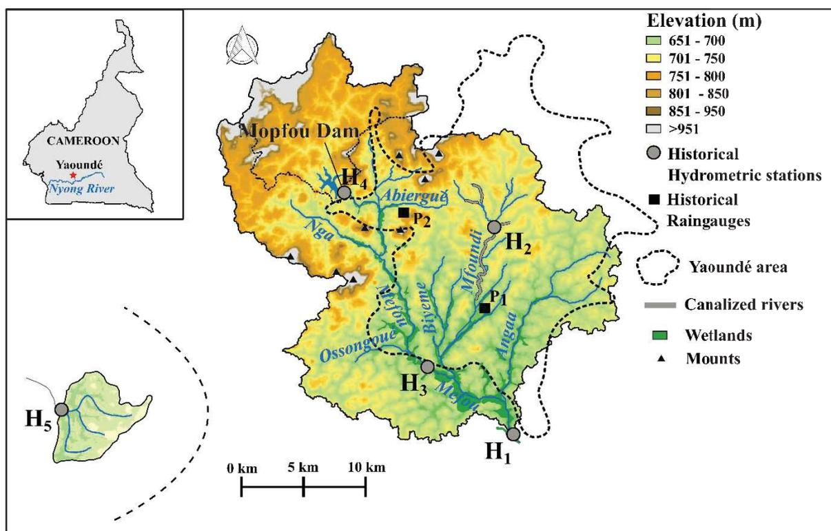
**Figure 3.2.** Présentation de la topographie et du réseau hydrographique du bassin de la Méfou à Nsimalen. H<sub>1</sub> à H<sub>5</sub> sont des stations hydrométriques historiques, seule la station H<sub>1</sub> présente des chroniques sur une longue période.
