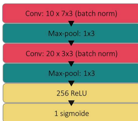
FIGURE 8.2 – Configuration du CNN pour la détection d'onsets spécifiques.
