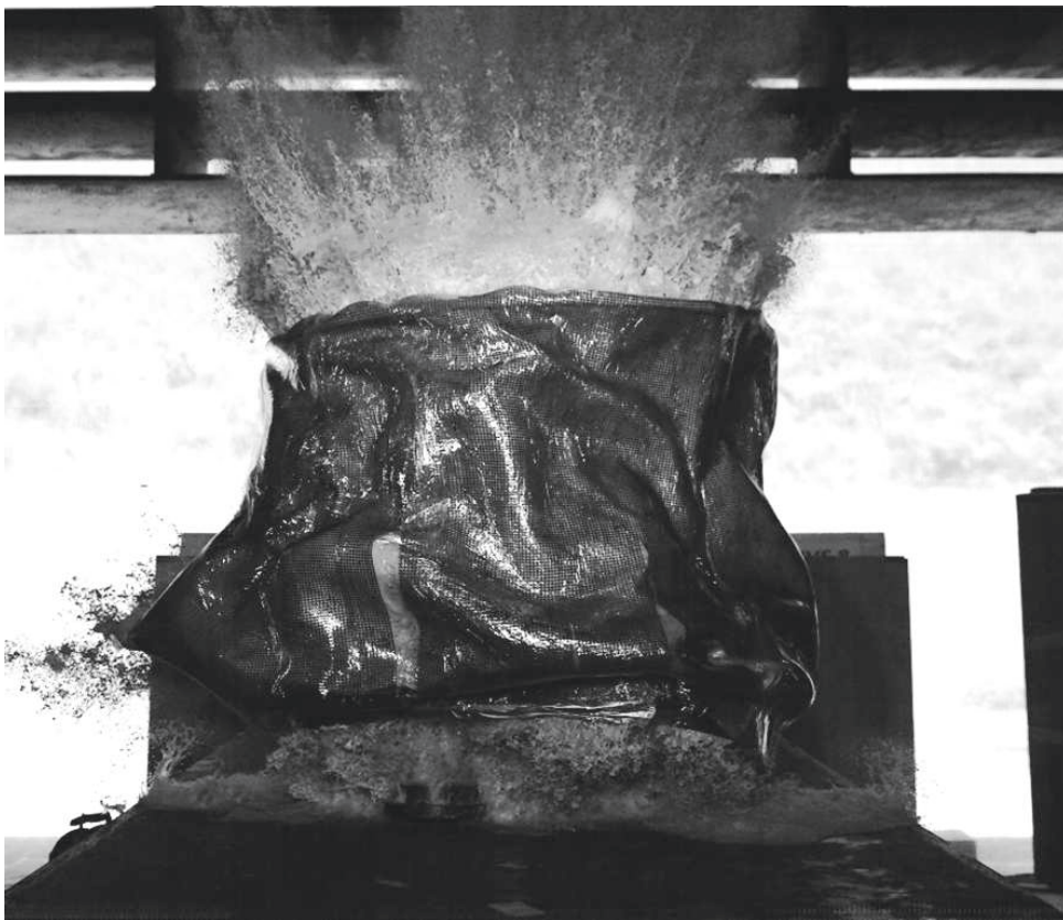
(a) Éjection de la mousse, enveloppant des particules, en partie haute et sur la surface latérale du confinement
