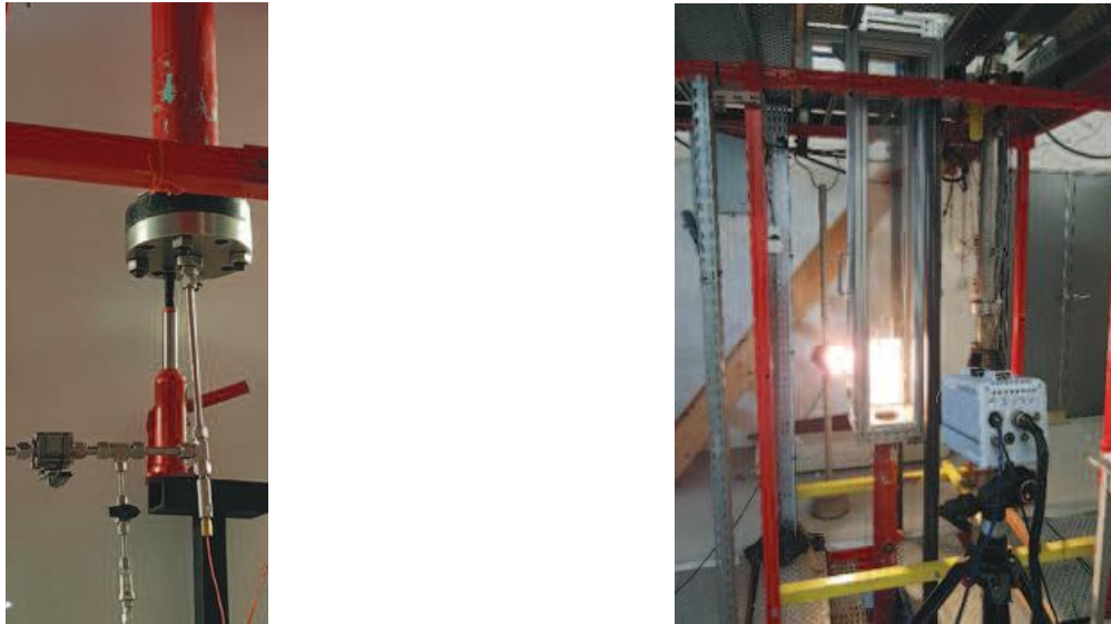
Figure 5.17 – Photographie du dispositif tube à détonation : système d'injection du gaz dans le booster et d'amorçage (à gauche) et enceinte transparente recevant la mousse (à droite) avec le projecteur halogène et la caméra pour l'enregistrement du phénomène.
