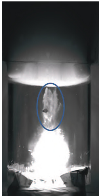
(c) entrée des particules pour h_m = 30 cm
