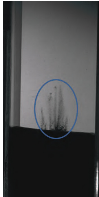
(b) sortie des particules pour h_m = 25 cm
