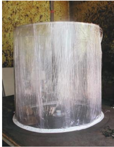
Figure 7.7 – Grillage recouvert d'un film plastique, mis en œuvre sur dalle, pour contenir la mousse, lors de la campagne ADAM 3
