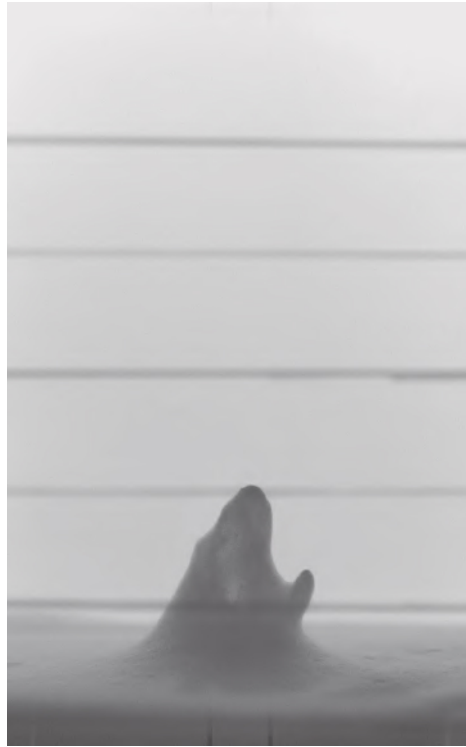
Figure 5.13 – Déformation de la surface libre de mousse pour h_m = 12,5 cm à t = 20,8 s
