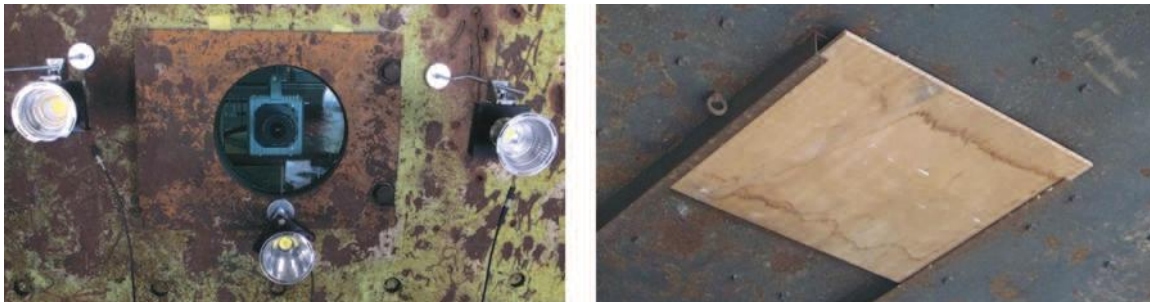
Figure 7.8 – A gauche : système de visualisation avec la caméra ultra-rapide au centre, et trois éclairages leds. À droite : vue de la plaque en bois fixée au plafond.
