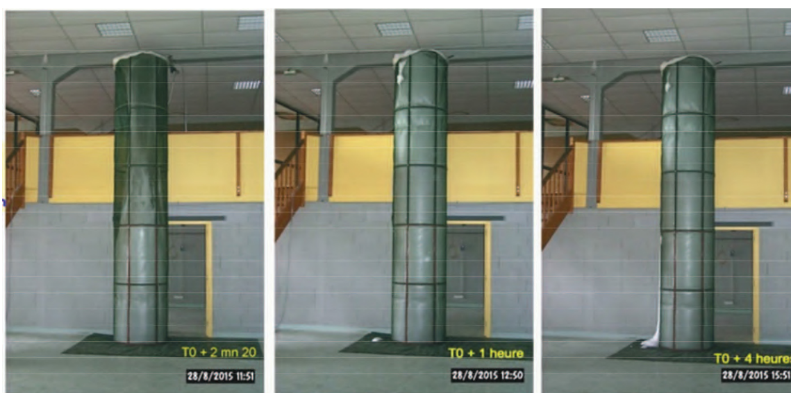
Figure 2.11 – Stabilité du R3x, sur une hauteur de 5 m, au bout de 4 heures [22]
