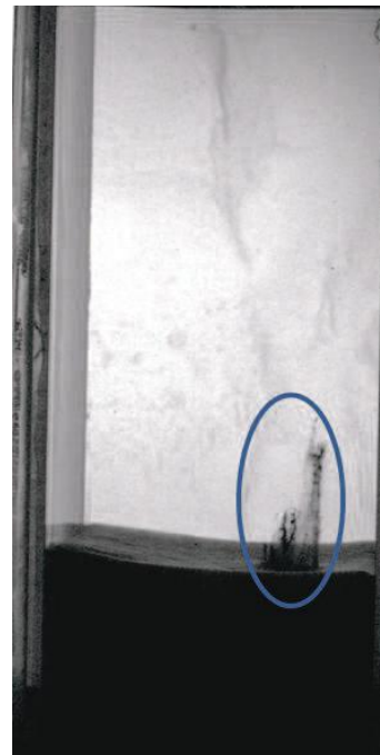
(d) sortie des particules pour h_m = 20 cm
