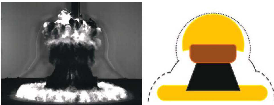
Figure 7.12 – Image et schématisation de l'onde de choc et des produits de détonation générés par la détonation d'une charge cylindrique (essai 20-S-S-S)
