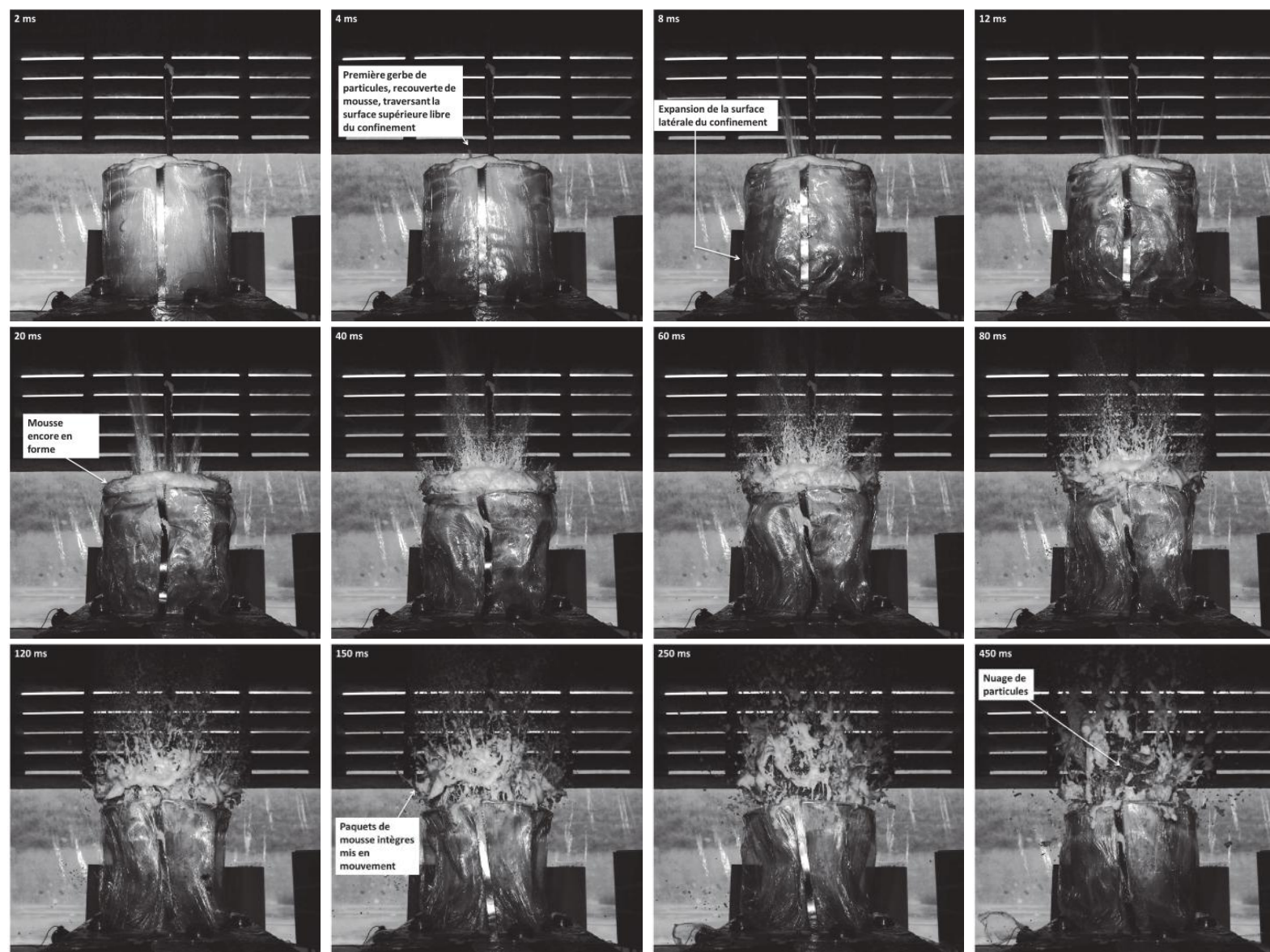
Figure 7.18 – Projection des particules et des produits de détonation, lors de l’essai 20-P 3 -88-PC (champ optique : 1024 x 1024 mm 2 )
