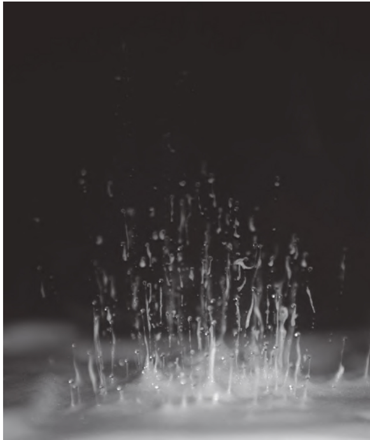
Figure 4.7 – Photographie de la sortie de billes de verre de la surface libre de la mousse
