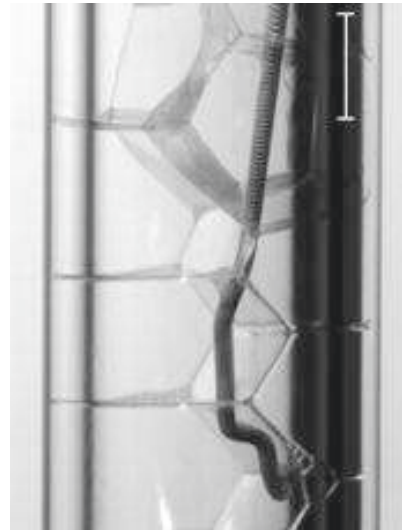
(b) Superposition d'images issues de la vidéo de la trajectoire d'une bille d'aluminium lâchée dans une mousse à structure cristalline
