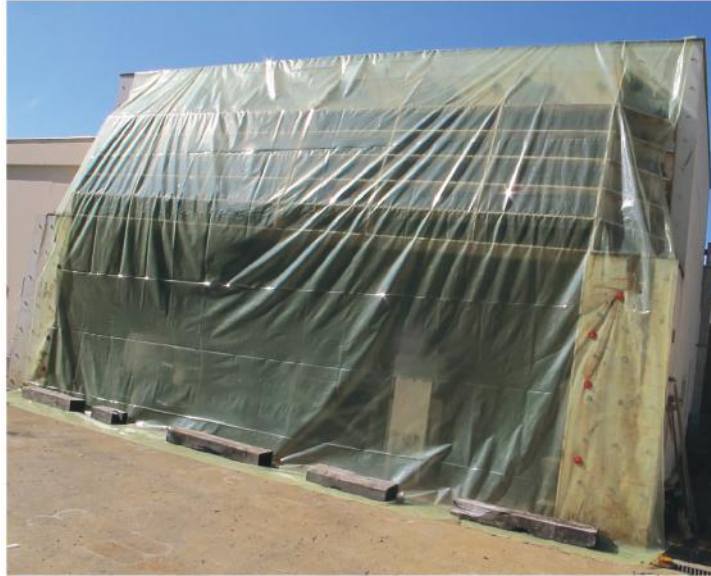
Figure 7.10 – Casemate d'expérimentation fermée par une bâche en vinyle
