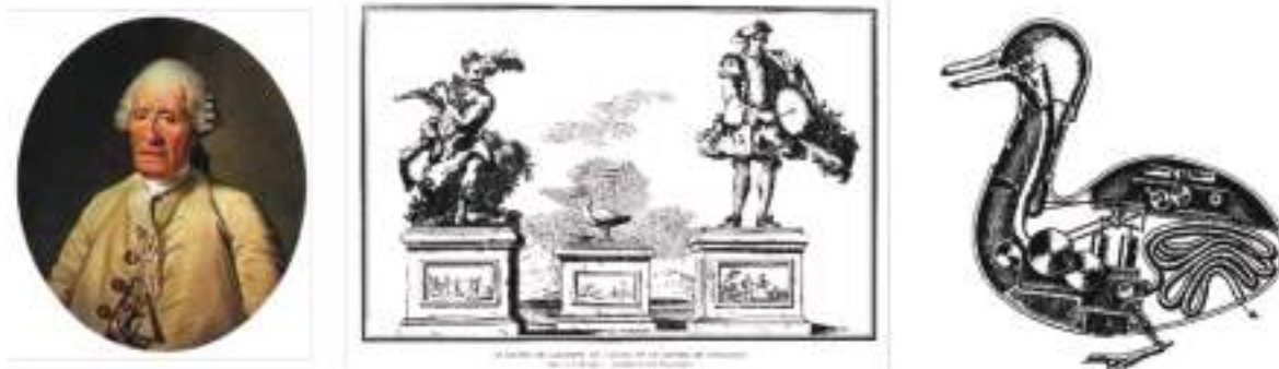
Figure 4 Représentation de Jacques de Vaucanson et gravure représentant le joueur de flûte, le canard et le joueur de tambourin. A droite, une vue en coupe présentant le mécanisme animant le canard.
