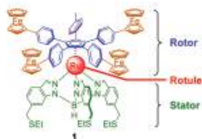
Figure 29 Structure du moteur moléculaire unidirectionnel et réversible synthétisé dans le groupe. [31]
