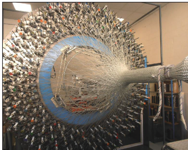
Figure I-5 : Machine à tresser circulaire 3D de la société Spiraltex (Projet SAGANE)
