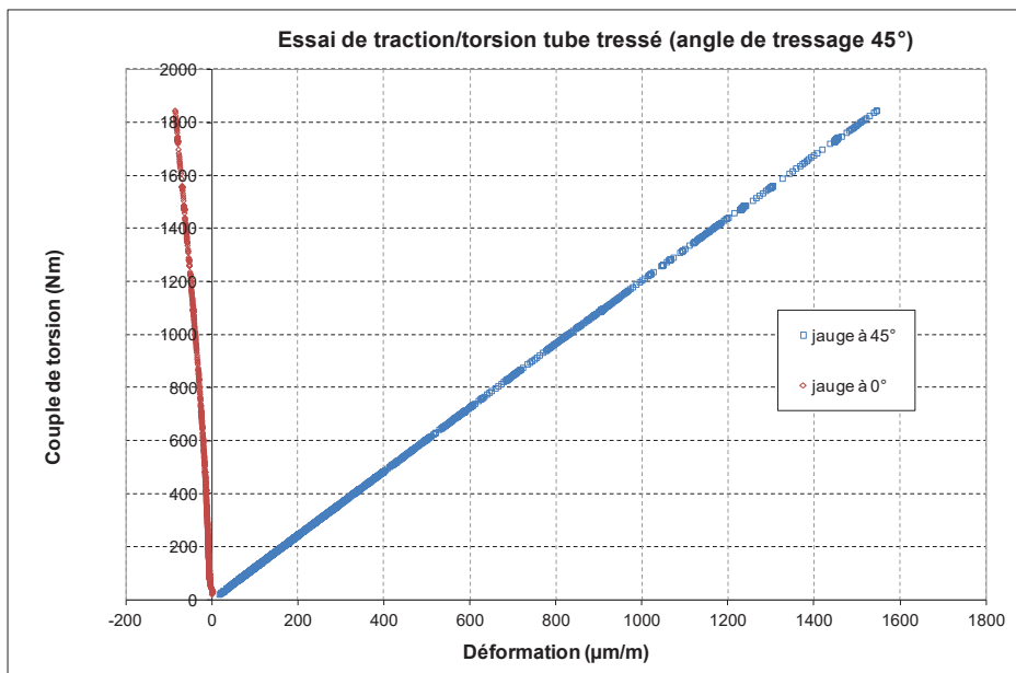
Figure III-23 : Déformations mesurées pour une éprouvette (angle de tissage 45°) sollicitée en torsion+traction
