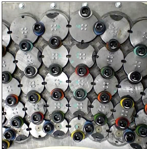
Figure III-32 : Position initial des fuseaux sur le plateau de tissage
