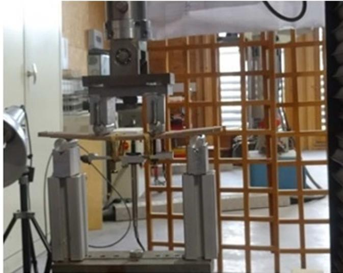
Figure 4.19 : Banc d'essai de flexion 4 points
