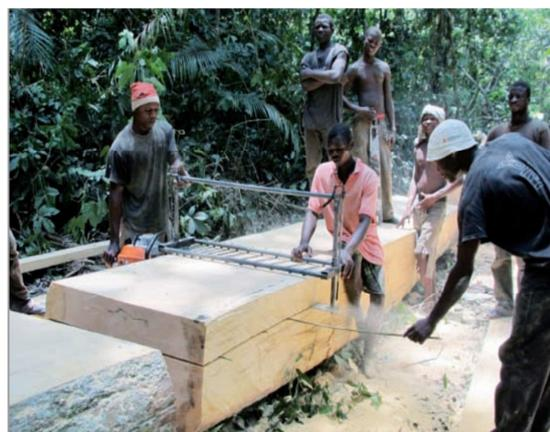
Figure 1.2 : Scierie à chaîne portable (RCA). © FAO/M. Vandenhaute
