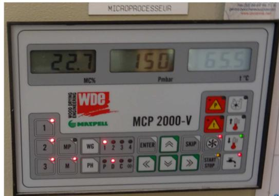
Figure2 : Teneur en eau du CP et pression dans l'enceinte de séchage pour une température de 65°C, renseignées par un microprocesseur.
