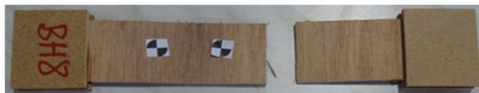
Figure 3.14 : Exemple de rupture d'éprouvettes de bété testées dans la direction perpendiculaire au fil du bois
