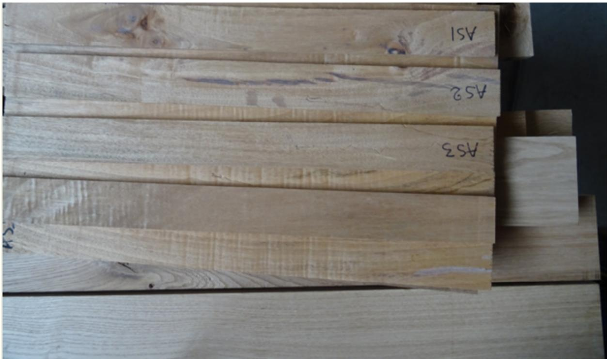
Figure 4.18 : éprouvettes des différentes essences pour le test de flexion à quatre points.
