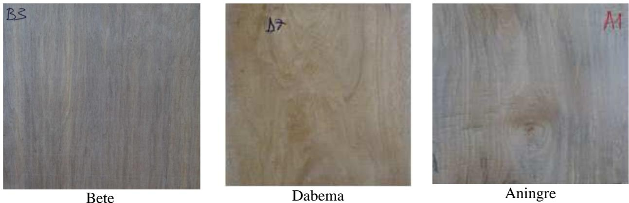
Figure 4. 11: CP du Bété, du Dabéma et de l'aningré issus du cycle séchage/humidification sous vide
