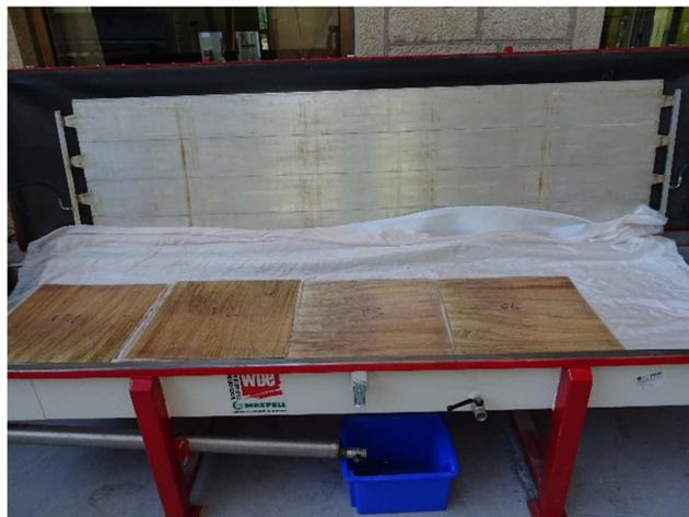
*Figure 4. 6: Disposition des CP dans le séchoir*
