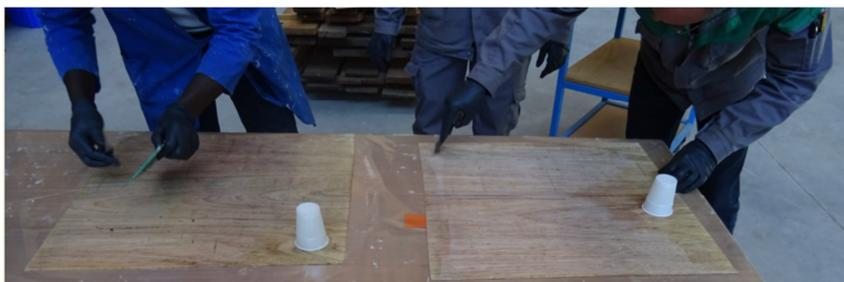
*Figure 4.5: Préparation des contreplaqués : encollage des plis*
