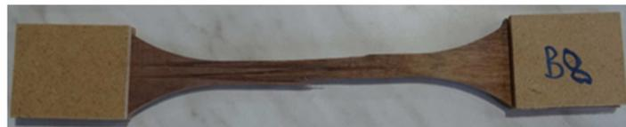
Figure 3.13 : Exemple de rupture d'éprouvettes de bété testées dans la direction des fibres
