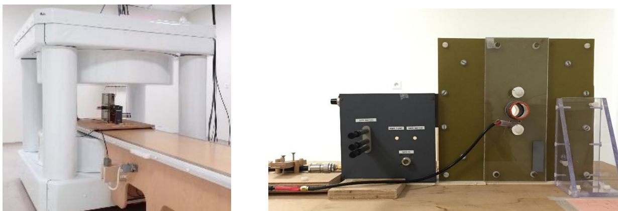
Figure 16 : Photographies de l'IRM 0.194T et de la cavité résonante RPE, placée au centre de l'aimant
