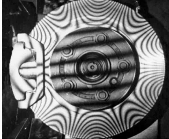
FIGURE 1.3 – Figure de franges d’interférences illustrant la déformée d’un système de frein à disque automobile crissant
