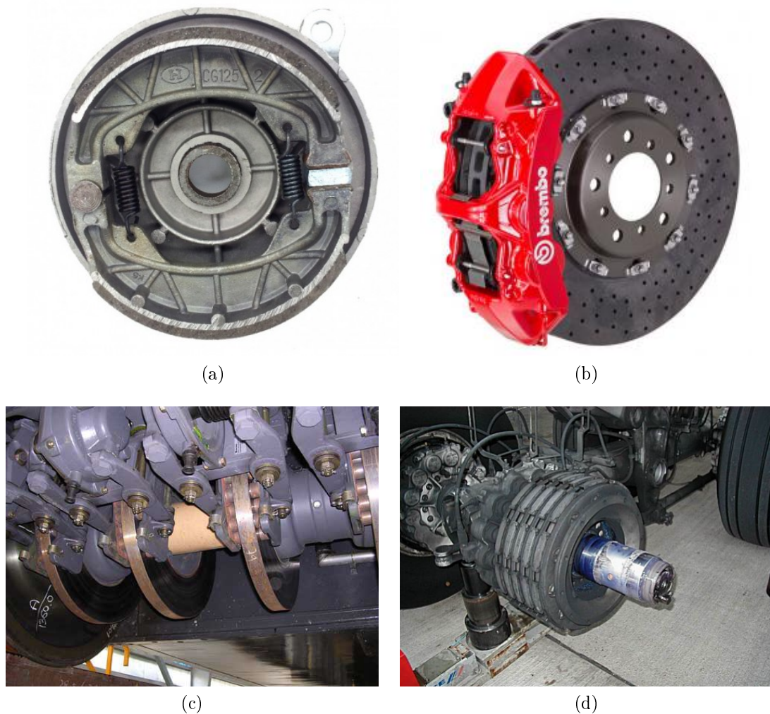
FIGURE 1.1 – Représentation de différents systèmes de freins, (a) frein tambour, (b) frein à disque automobile, (c) frein de TGV et (d) frein aéronautique
