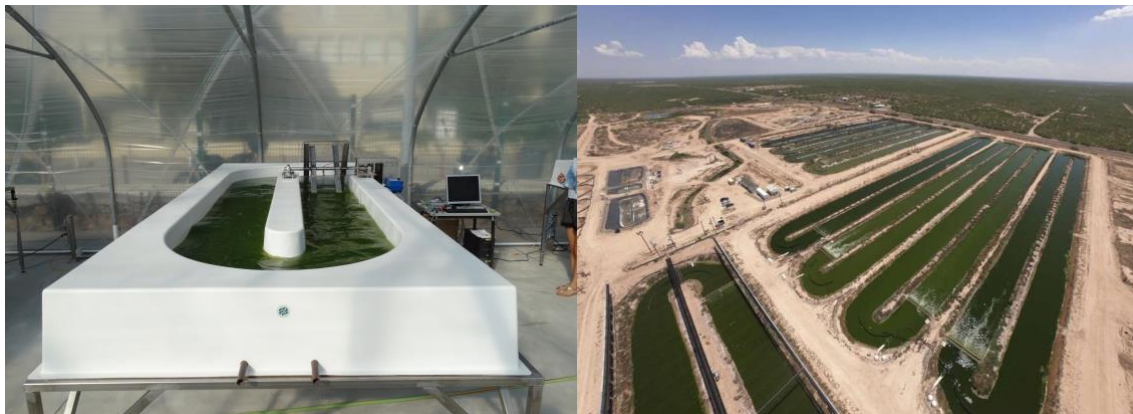
Figure 1 : Bassin ouvert de 2,61 m 2 de culture de D. salina à Villefranche-sur-Mer ; ferme de 20 hectares de Nannochloropsis sp. au Texas par Qualitas Health
