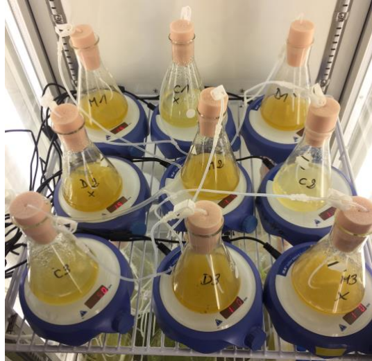
Figure 9 : Configuration expérimentale de mono-cultures et de co-cultures de D. salina et de C. watsonii en erlenmeyer dans l'incubateur.
