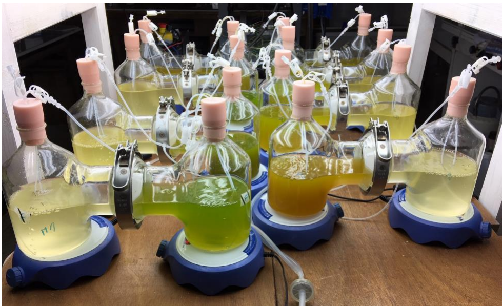
Figure 11 : Configuration expérimentale de mono-cultures et de co-cultures de D. salina et de C. watsonii avec et sans séparation membranaire.
