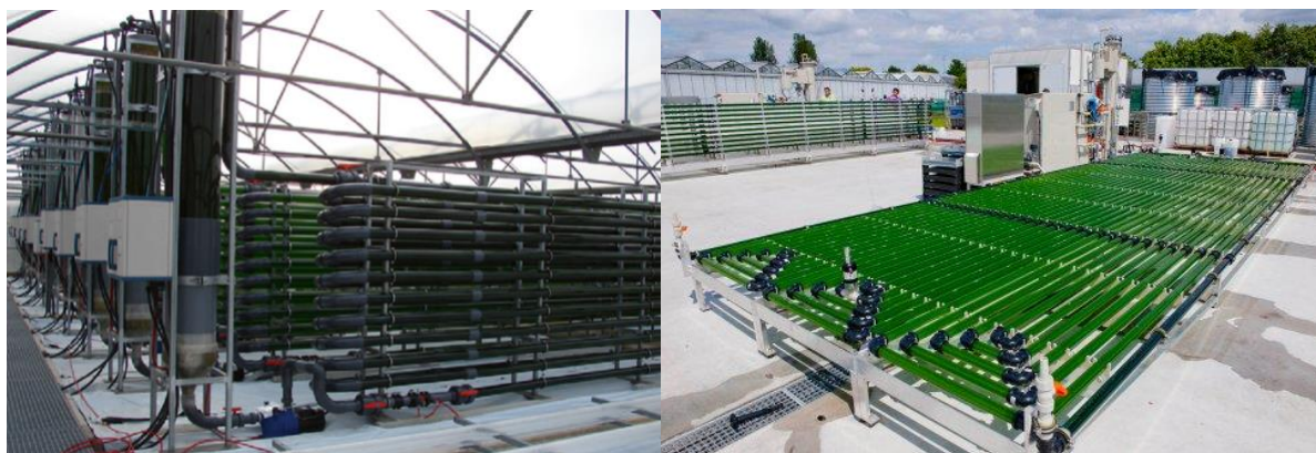
Figure 2 : PBRs verticaux à la Fondation Cajamar par l'Université d'Almeria ; PBRs horizontaux à l'Université de Wageningen par AlgaePARC
