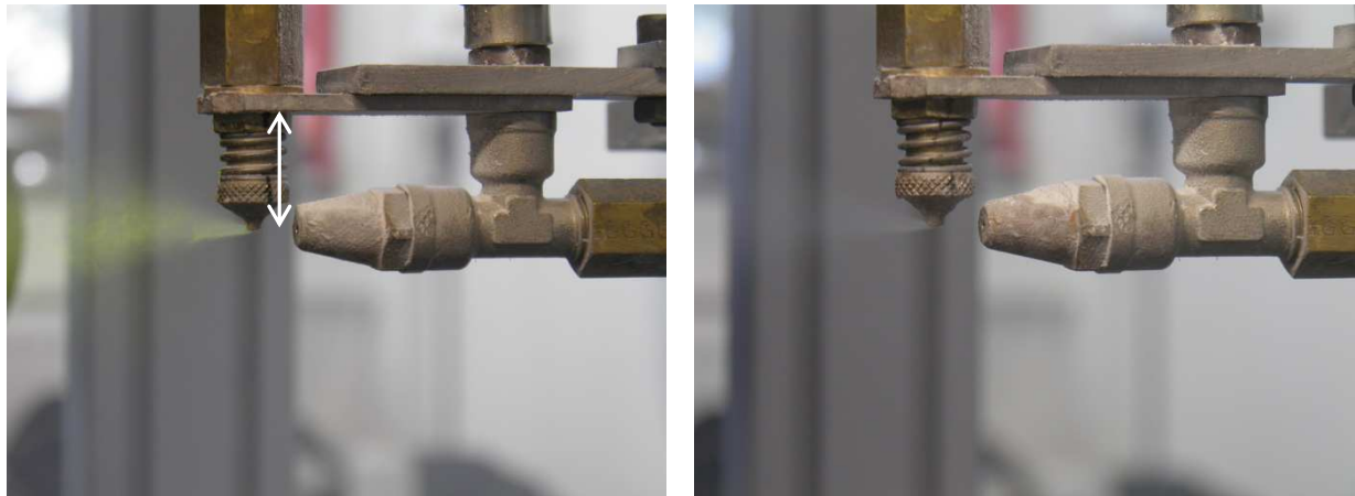
Figure 50 – Photographies des meilleurs réglages de pulvérisation pour le F34 (a) et le F140 (b)
