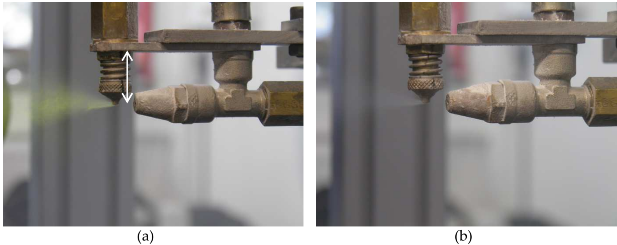
Figure 50 – Photographies des meilleurs réglages de pulvérisation pour le F34 (a) et le F140 (b)
