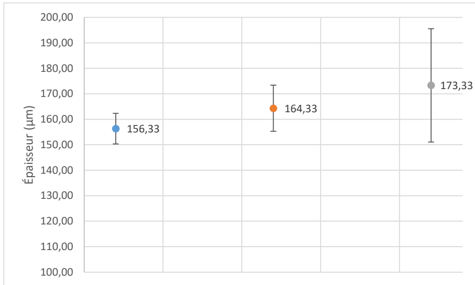
Figure 112 : Influence de l'ajout d'additifs sur l'épaisseur des films de vernis réticulés au QUV
