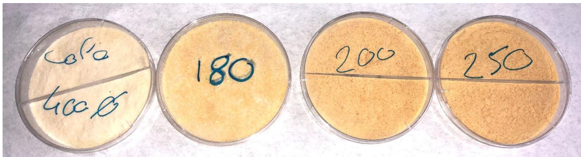
Figure 55 : Aspect visuelle des colophanes non traitées et traitées thermiquement à 180 °C, 200 °C et 250 °C
