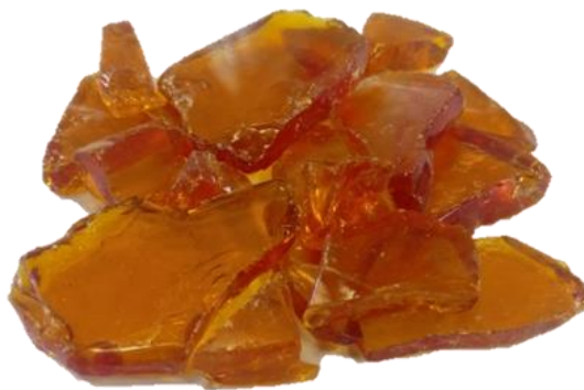
Figure 6 : Colophane de pin maritime (séchée à 150 °C pendant 16 h)
