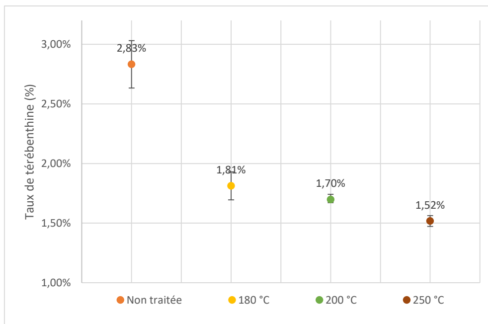
Figure 62 : Comparaison du taux de térébenthine selon le traitement thermique
