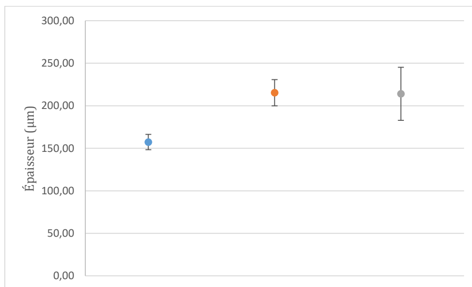
Figure 108 : Influence des additifs sur l'épaisseur du film de vernis
