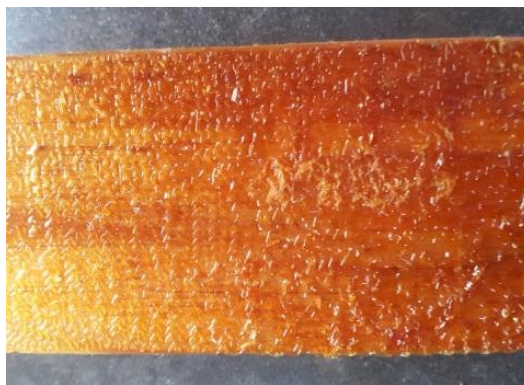
Figure 84 : Effet du manganèse sur le film de vernis appliqué sur le bois
