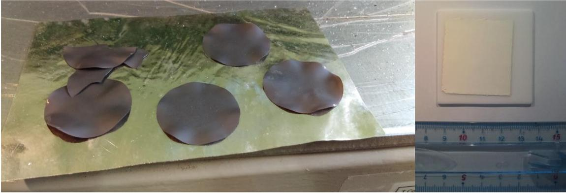
**Figure 4.2.** Echantillons de bandes minces de B<sub>T</sub>Co sans préfrittage présentant l'effet « chips » (gauche), de BT frittées avec un cycle incluant un préfrittage et non déformées (droite)
