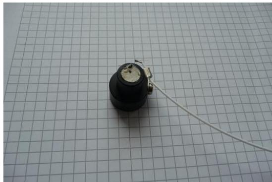
**Fig.1** Transducteur mono élément en BTCoLiG 1250°C 24h
