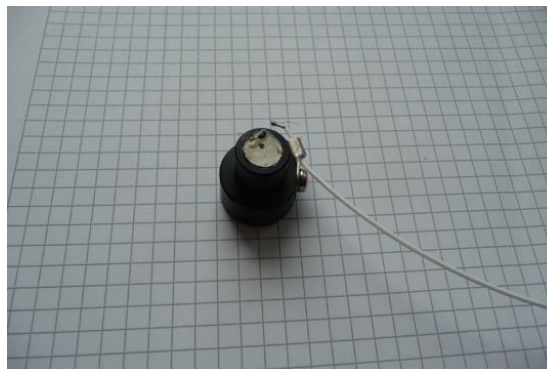
Fig.1 Transducteur mono élément en BTCoLiG 1250°C 24h
