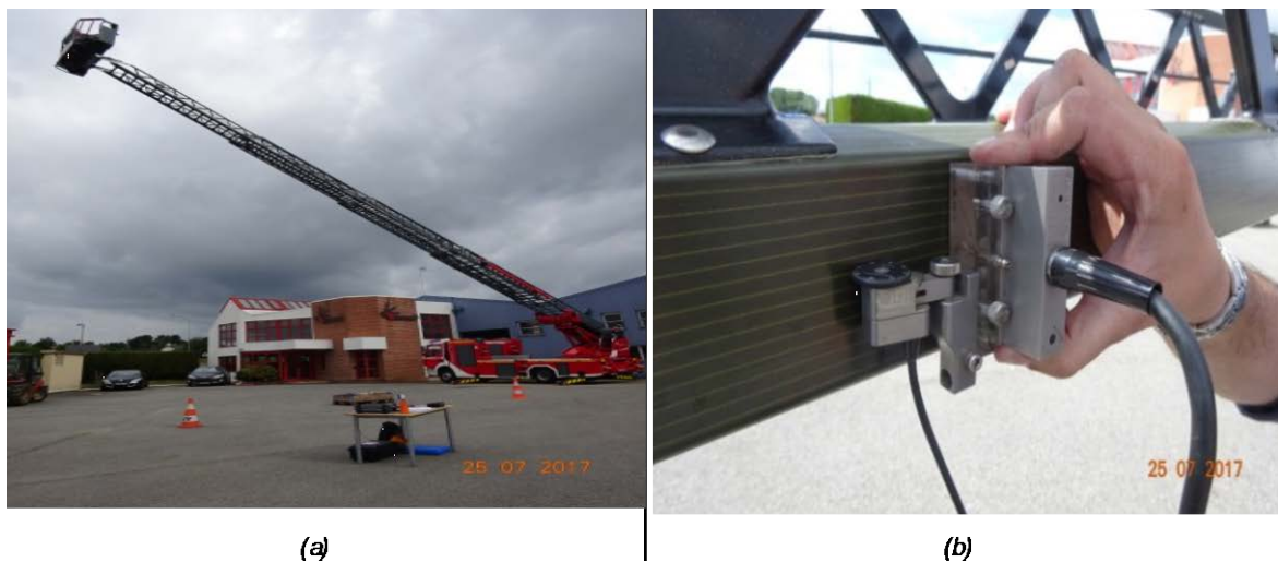
Figure 1-9. Contrôle CND ultrasons au contact au cours de la qualification d'un prototype d'échelle de pompier en composites.
