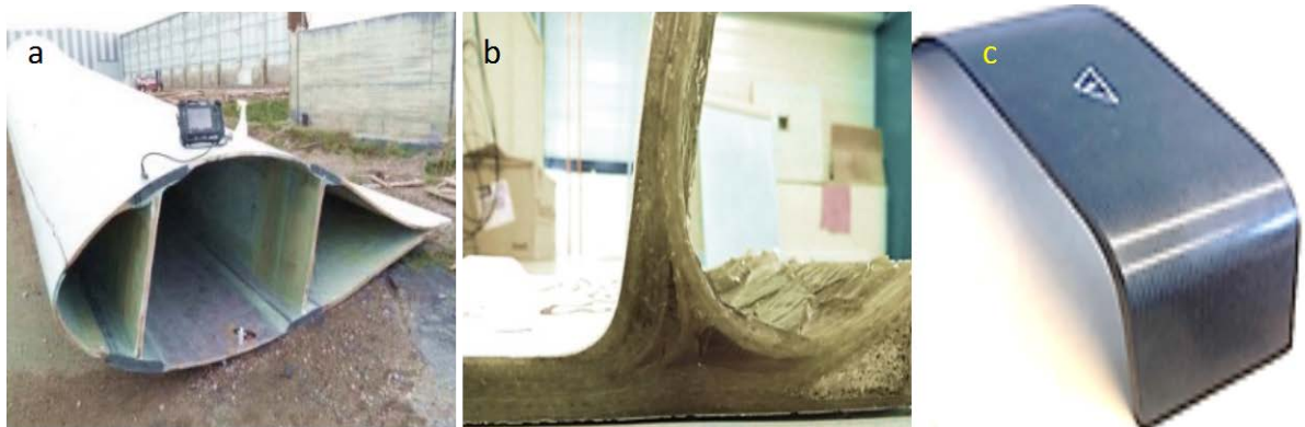
Figure 1 : Différentes structures composites épaisses (a) pale d'éolienne, (b) coque de bateau et (c) prothèse de pied.
