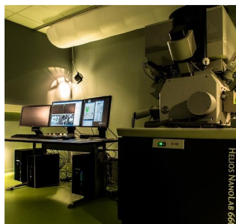
Figure IV-9 – Schéma de principe du Dual Beam. Le système utilisé pour la préparation des lames minces (FEI-HELIOS 660) est équipé d'une colonne de microscope électronique à balayage à émission de champ (Elstar) et d'une colonne à faisceau d'ions gallium (Tomahawk).
