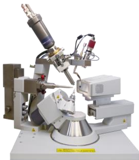
Figure A-6 – Diffractomètre monocristal 4 cercles – Laboratoire CRISMAT
