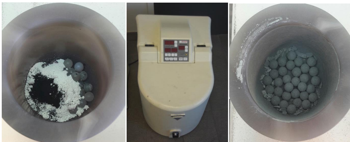
Figure A-2 – Photographies lors de la préparation des poudres. Présentation du mélange des précurseurs avant (gauche) et après (droite) utilisation du broyeur planétaire (milieu).
